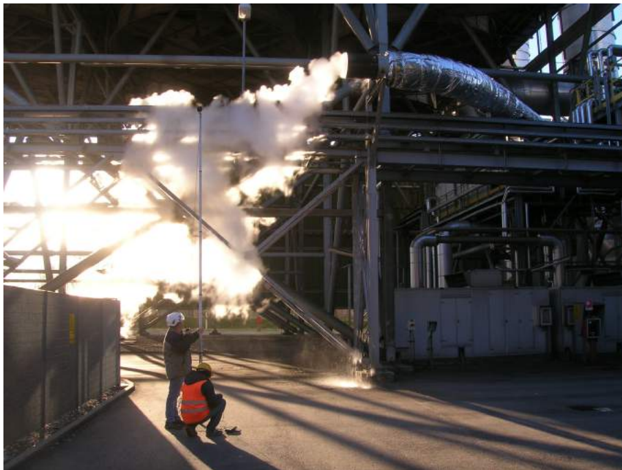
FOTO 2 –EIETTORE DI AVVIAMENTO DURANTE TEST DIURNI DI EMISSIONE SONORA IN MODALITÀ DI SOLO MANTENIMENTO (CENTRALE IN MARCIA)
