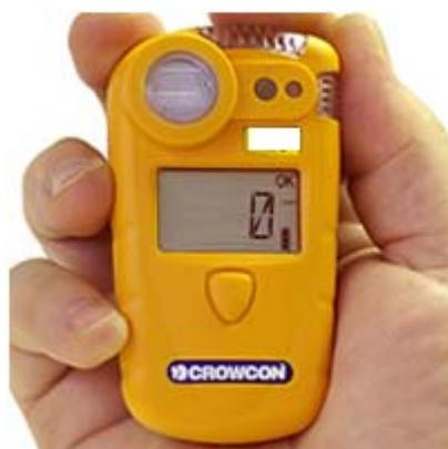
**Figura 3-3 Esplosivometro portatile Crowcon Gasman2**
