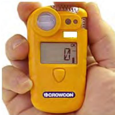
**Figura 3-2 Esplosivimetro portatile Crowcon Gasman2**
