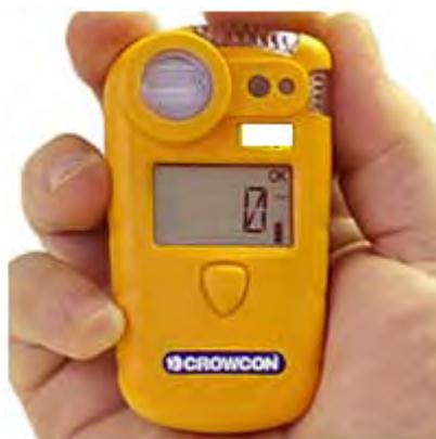
**Figura 3-3 Esplosivometro portatile Crowcon Gasman2**
