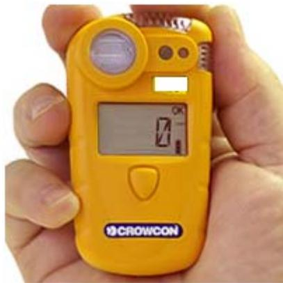
**Figura 3-3** Esplosivometro portatile Crowcon Gasman 2
