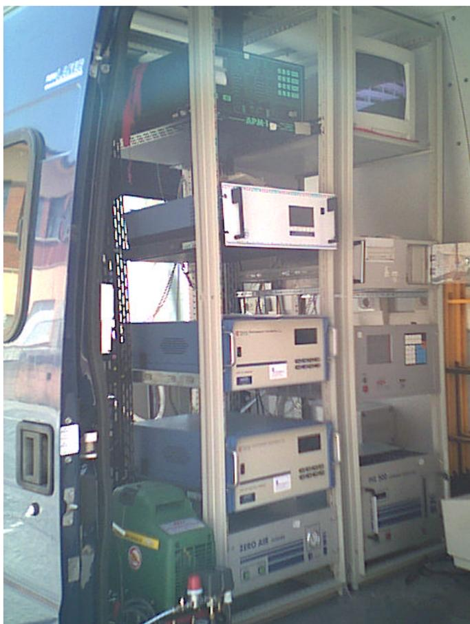
La stazione di monitoraggio è costituita da una unità mobile contenente gli strumenti necessari per il prelievo e l'analisi degli inquinanti, sulla quale è installata una centralina per la rilevazione dei dati meteorologici.
