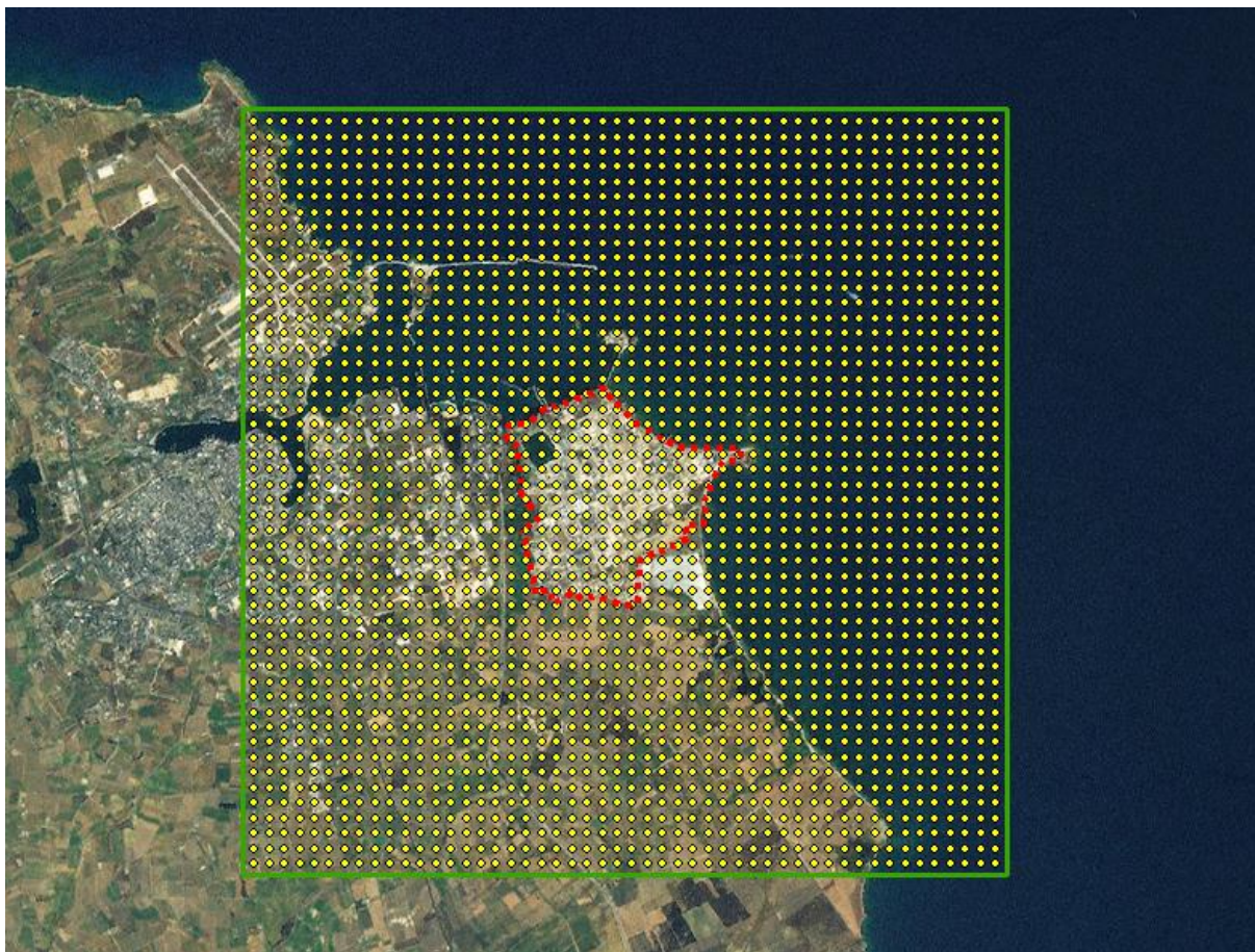
Figura 4-12: Localizzazione del dominio di calcolo (in verde), dei recettori considerati nelle simulazioni (in giallo) e del perimetro dell'impianto (in rosso).
