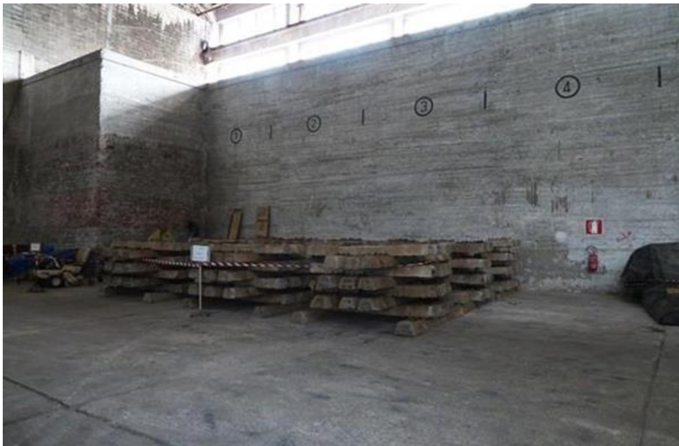
Fig. 4 Traversine in cemento da utilizzare ricollocate nel magazzino Lauro
