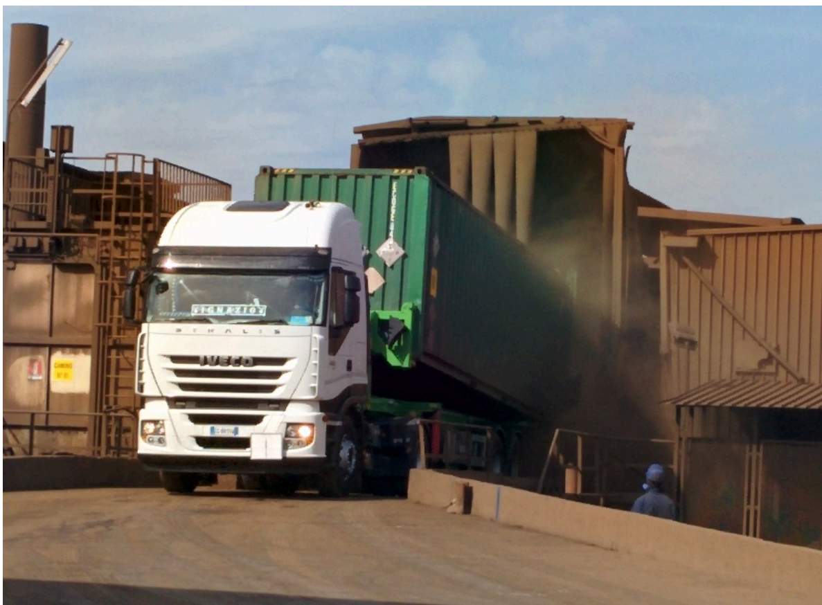
Foto 1 (sopra) del 06-10-15 area di scarico dei fumi di acciaieria in container – inizio fase di scarico dei fumi di acciaieria (codice CER 110202*) e produzione di polverosità.
