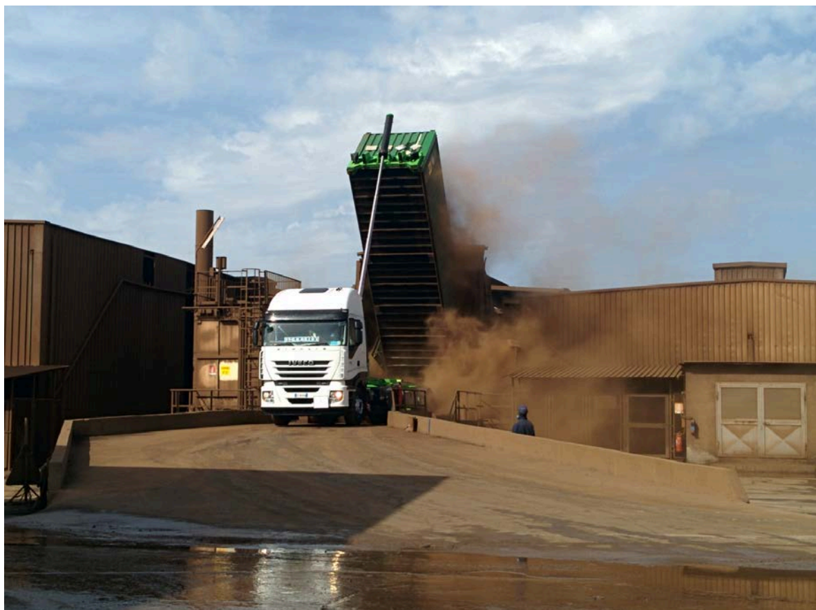
Foto 3 (sopra) del 06-10-15 area di scarico dei fumi di acciaieria in container – fase finale di scarico dei fumi di acciaieria (codice CER 110202*) e produzione di polverosità.
