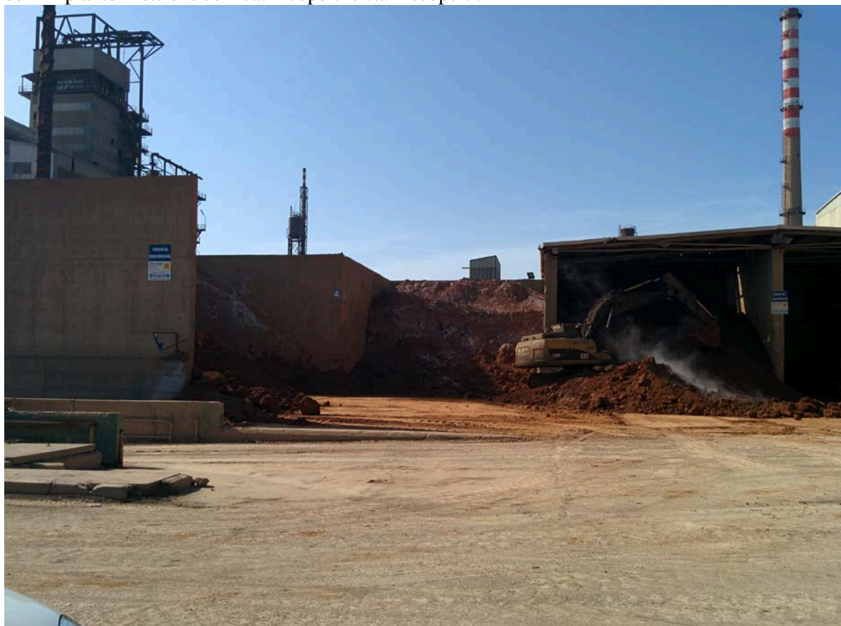
Foto 11 (sopra) del 06-10-15 deposito area n. 4 dei fanghi di conversione dal reparto lisciviazione dell'Impianto Elettrolitico - stalli coperti e stalli scoperti.
