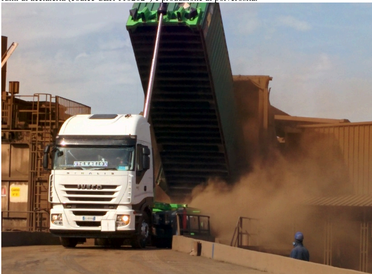
Foto 2 (sopra) del 06-10-15 area di scarico dei fumi di acciaieria in container – fase intermedia di scarico dei fumi di acciaieria (codice CER 110202*) e produzione di polverosità.
