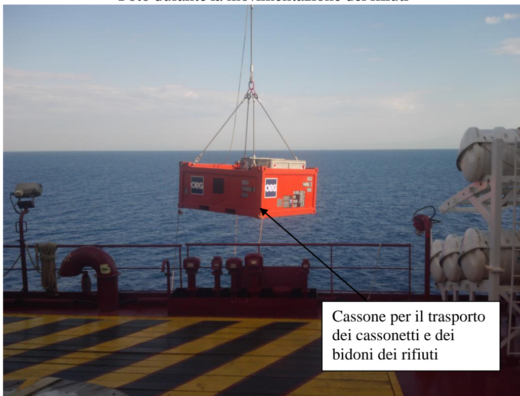
Figura 4: movimentazione con gru del cassone per il contenimento dei rifiuti (caricato di cassonetti vuoti)
