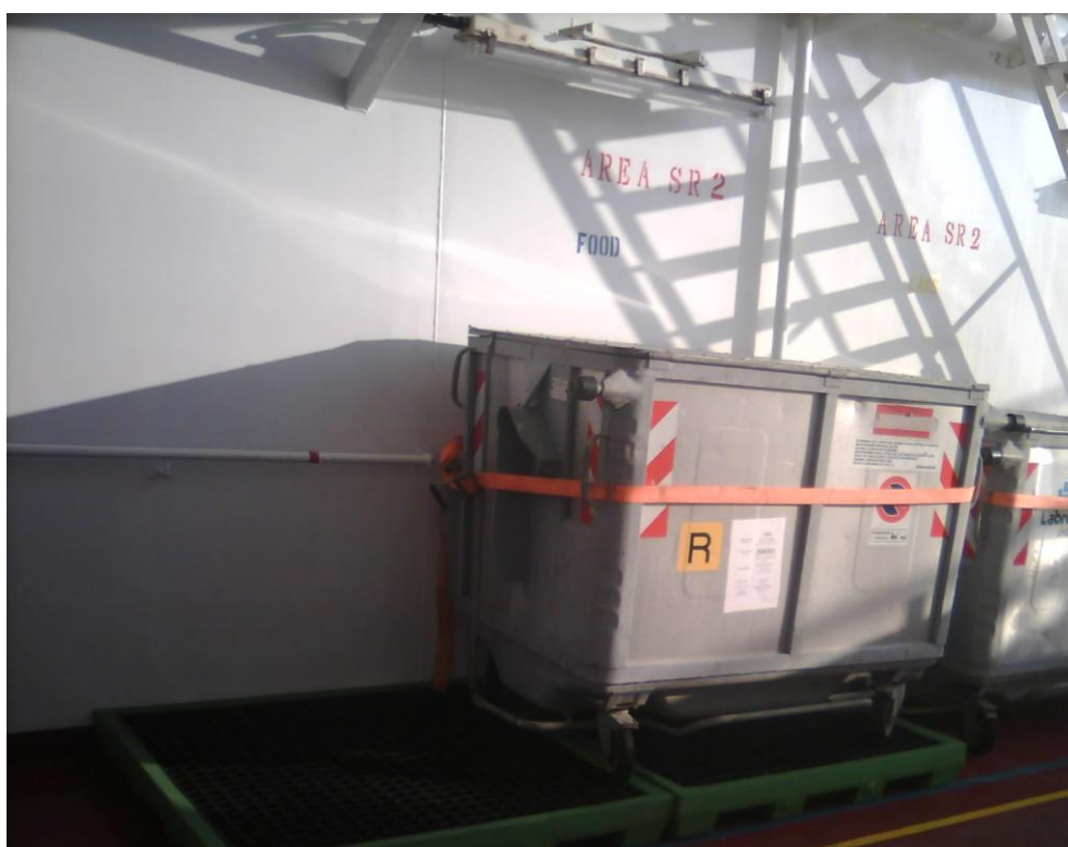
Figura 1: contenimento Rifiuti con possibilità di percolamento
