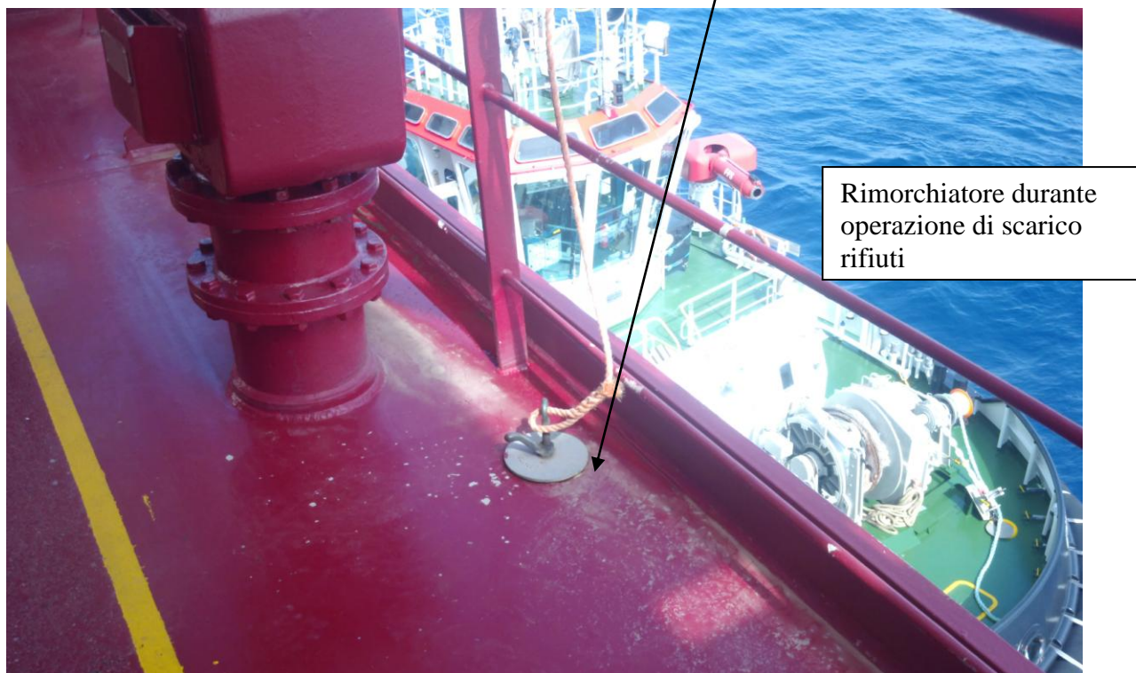
Figura 2: cordolo del Terminale e ombrinale chiuso
