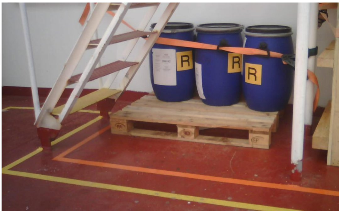
Figura 2: Rizzaggio ed etichettatura rifiuti solidi non pericolosi area SR1
