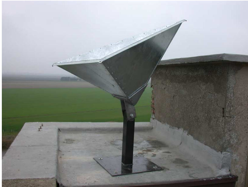
Figura 5. Riflettore artificiale passivo tipo Triangular Trihedral Corner Reflector .
