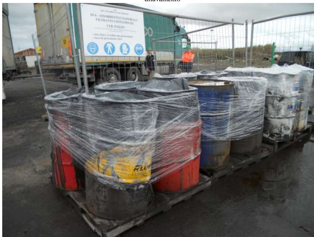
Foto 4 del 26-03-15 area n.6 di deposito temporaneo di rifiuti - mancanza di convogliamento delle acque di dilavamento e non adeguate modalità di copertura
