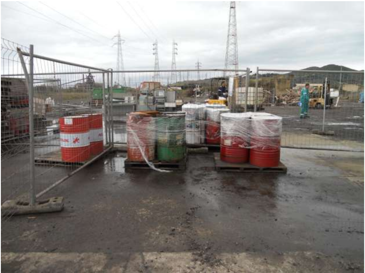
Foto 5 del 26-03-15 area n.6 di deposito temporaneo di rifiuti - mancanza di convogliamento delle acque di dilavamento e non adeguate modalità di copertura
