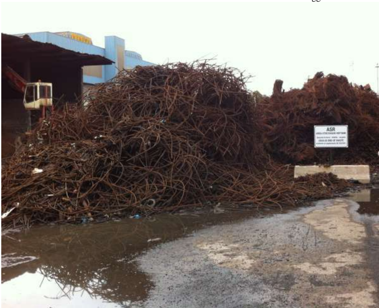
Foto 2 del 26-03-15 area stoccaggio rottami - mancanza di deflusso e convogliamento delle acque di dilavamento
