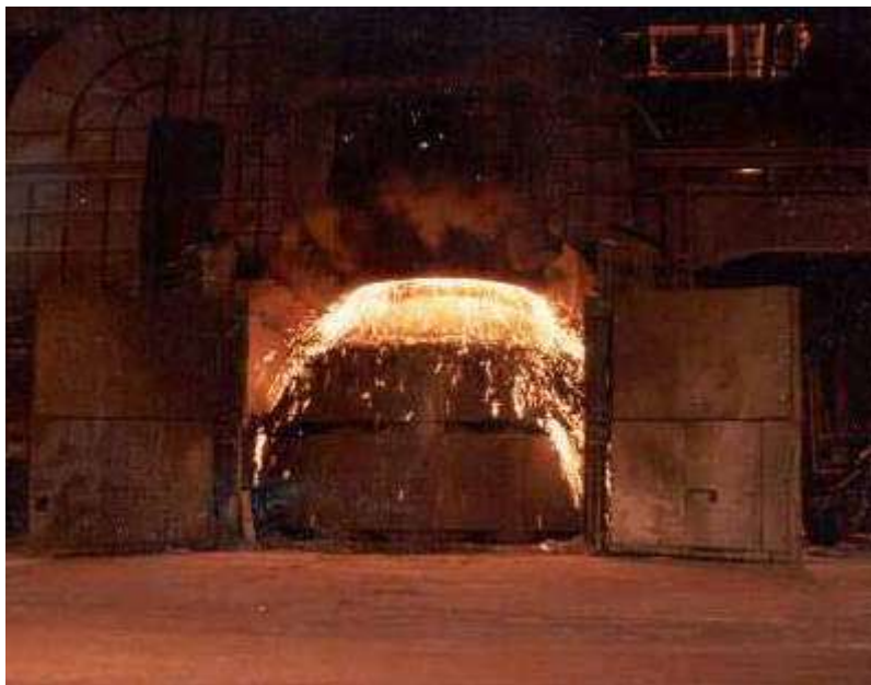
Soffiaggio in convertitore
