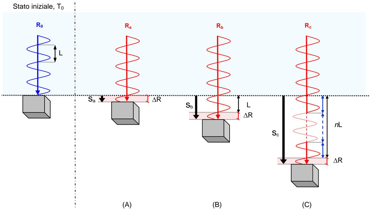
Figura 43: Esempio di equivocazione del moto del PS
