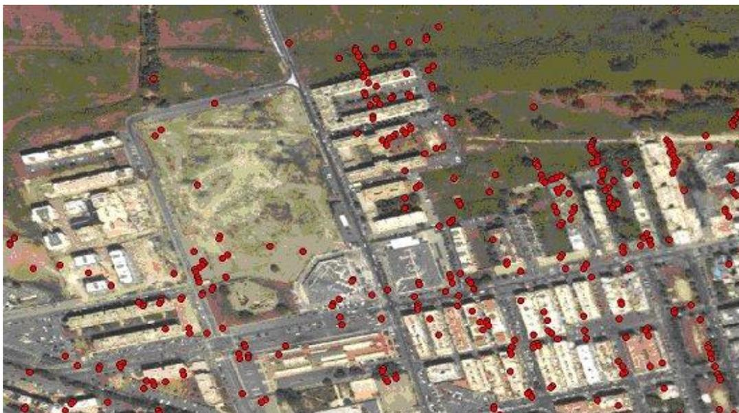
Figura 40: Disposizione dei PS non consistente con il layer usato come supporto cartografico.
