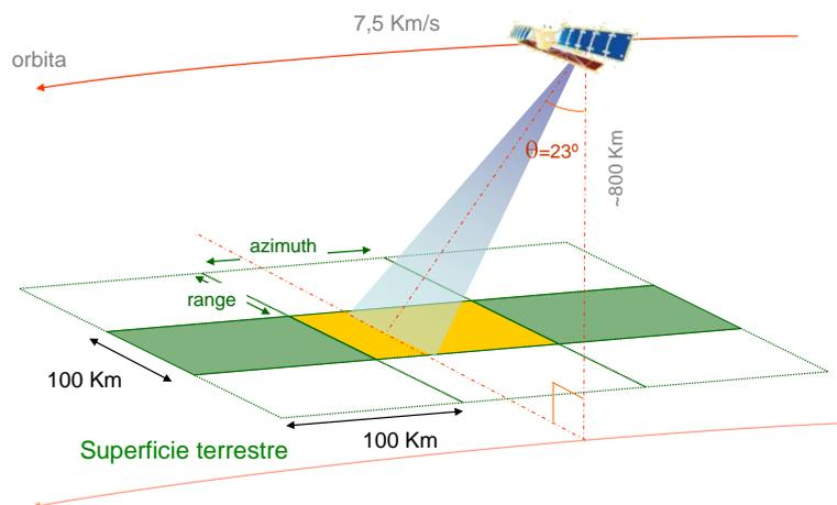
Figura 2: Geometria d'acquisizione SAR delle piattaforme ERS-1 ed ERS-2.
