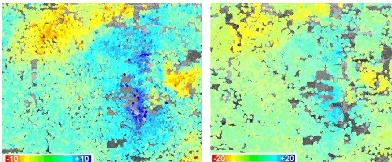
Figura 66: Visualizzazione del campo di velocità tramite l'utilizzo di scale cromatiche con estremi di variazione in valore assoluto pari a 20 mm/anno (a destra) ed a 10 mm/anno (a sinistra) all'interno della stessa area geografica.
