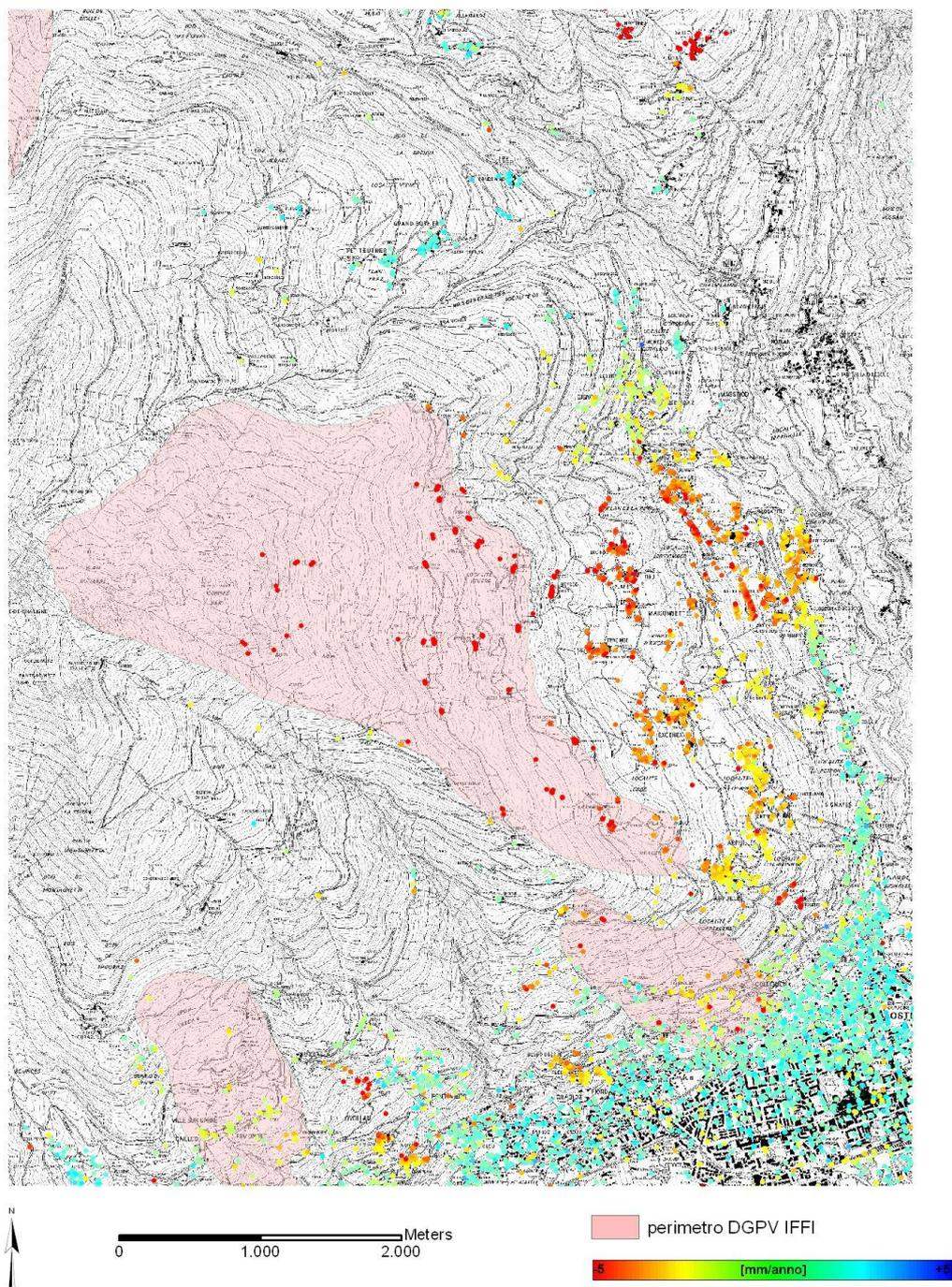
Figura 79: Particolare del campo di velocità sulla DGPV di P.ta Chalighe (AO). Analisi Ascendente.
