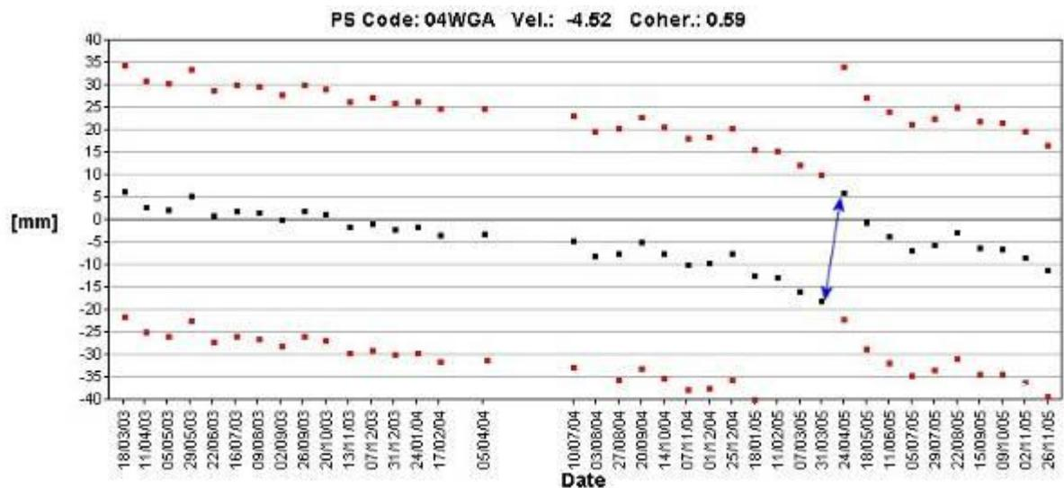
Figura 69: serie storica con errore di phase unwrapping.
