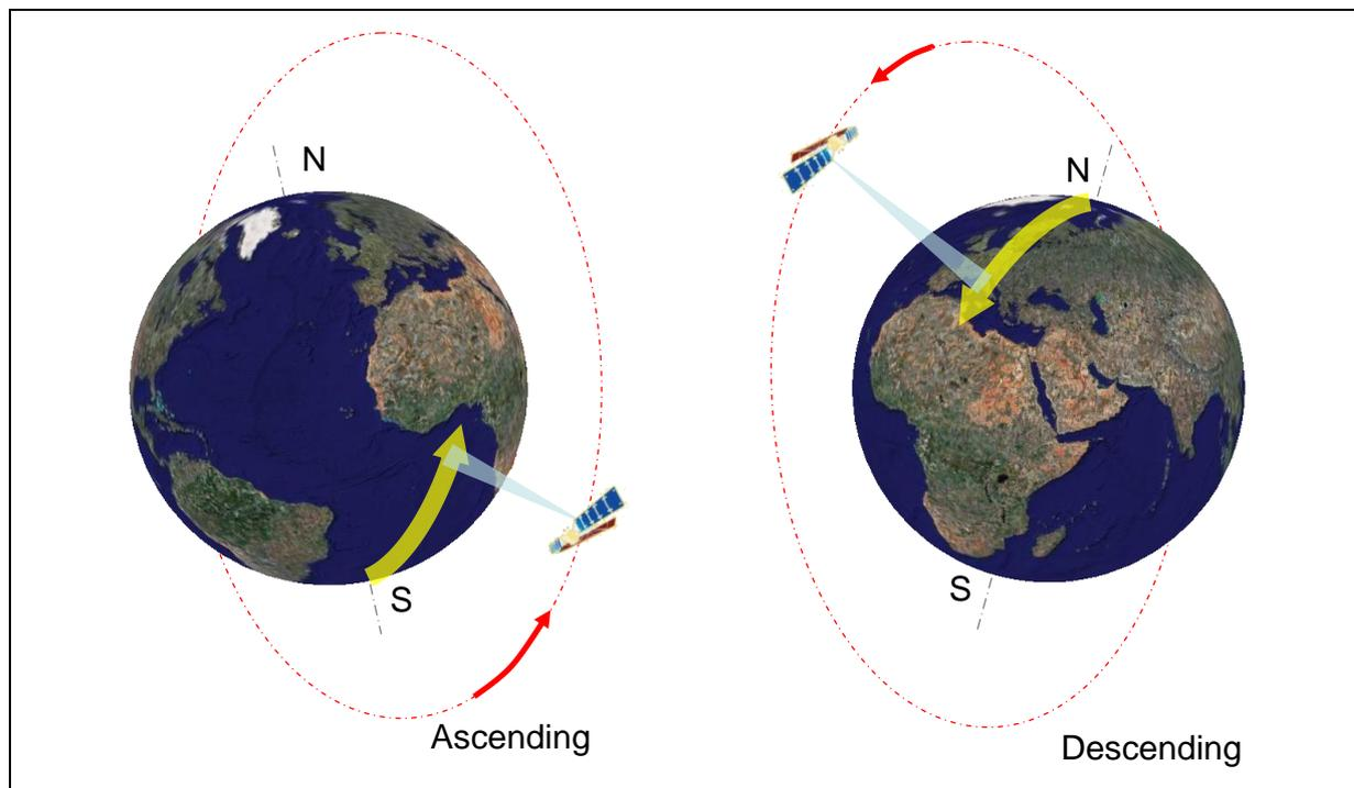
Figura 28: modalità di acquisizione. A sinistra modalità ascendente, a destra modalità discendente.
