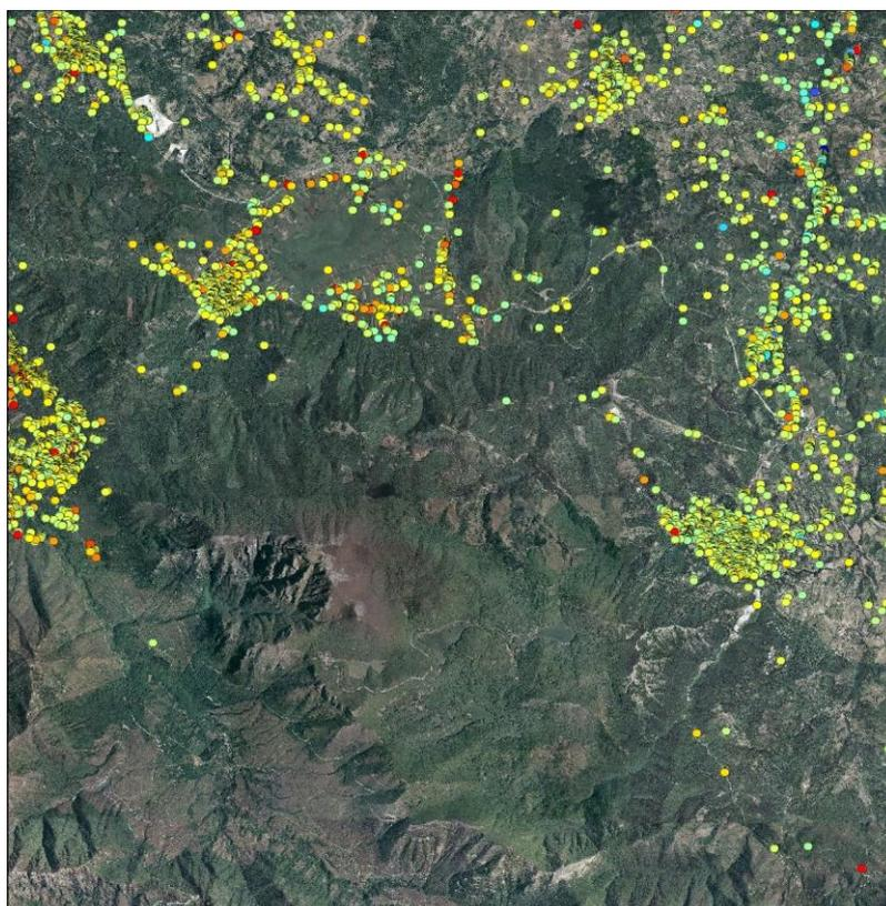
Figura 20: esempio di copertura PS. Risulta evidente la concentrazione dei PS sulle zone urbanizzate mentre le zone vegetate non risultano coperte da punti di misura.
