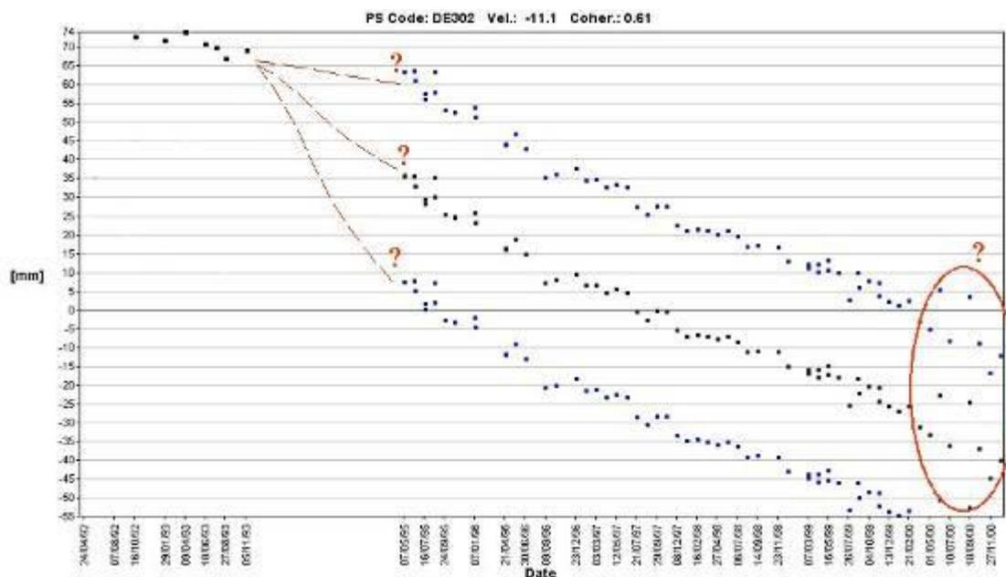
Figura 68: Esempio di *phase unwrapping*
