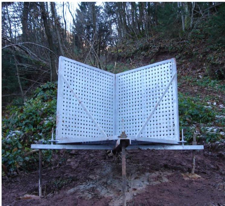
Figura 26: Esempio di installazione di triedro quadrato in ambiente montuoso per il monitoraggio di un versante in frana.
