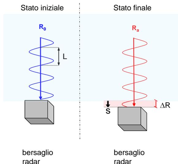
Figura 9: Rappresentazione schematica del principio interferometrico.
