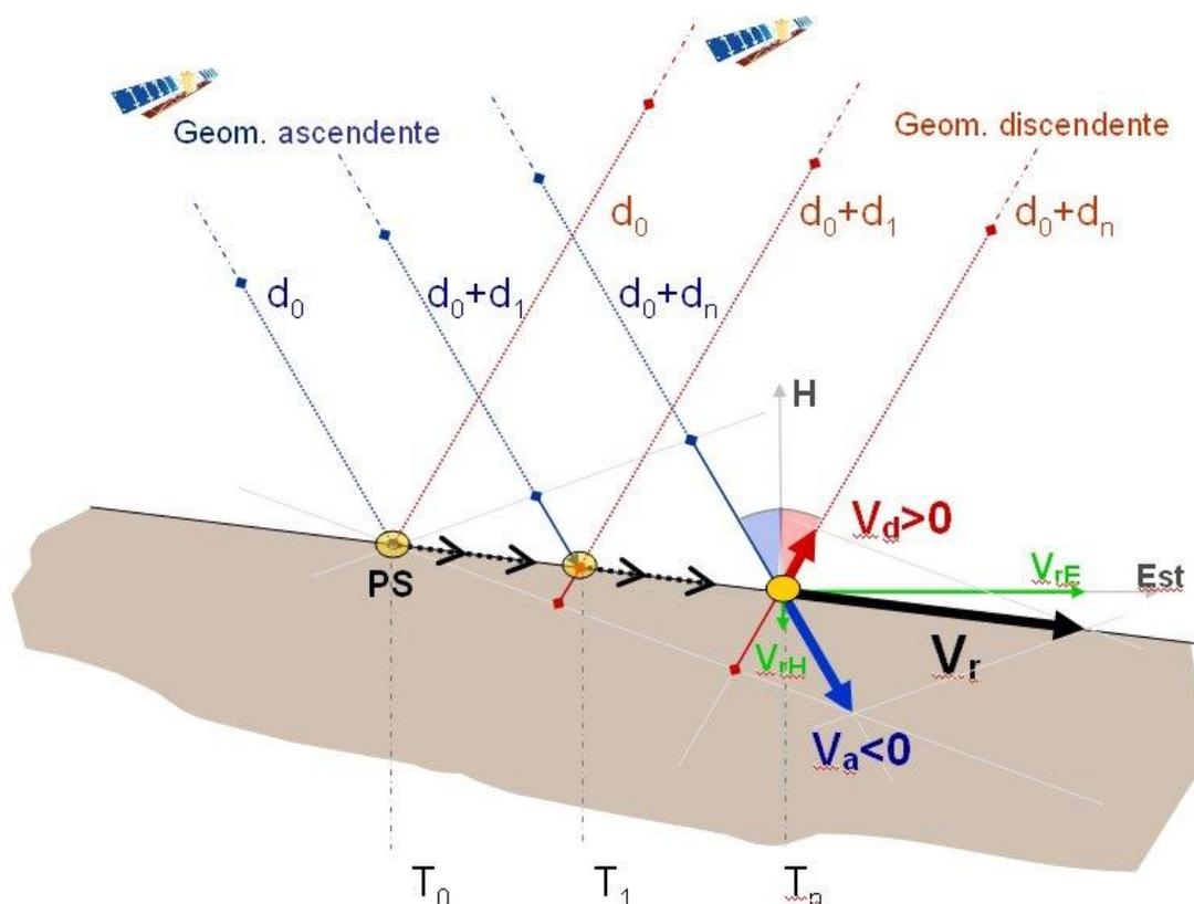
Figura 35: Esempio di scomposizione del moto combinando i dati di velocità ascendente e discendente
