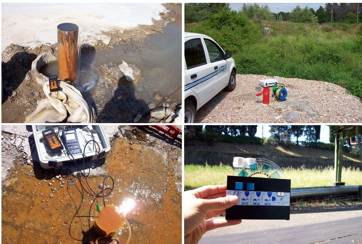
Foto 1-4. Operazioni di misura e campionamento. Pozzo artesiano di acque termali in località Pagliari (foto in alto a sinistra), piezometro nell'area dei bacini ceneri ENEL (foto in alto a destra), misure su acque ferruginose di un piezometro in prossimità del carbonile di Val Bosca (foto in basso a sinistra), misura dei solfuri (foto in basso a destra).
