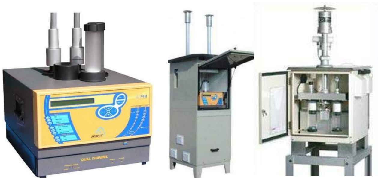
Figura 4: Strumentazione impiegata per il prelievo delle polveri su membrane da 47 mm. Da sinistra: SWAM 5a Dual Channel, Hydra Dual Sampler nel suo alloggiamento, Skypost TM.
