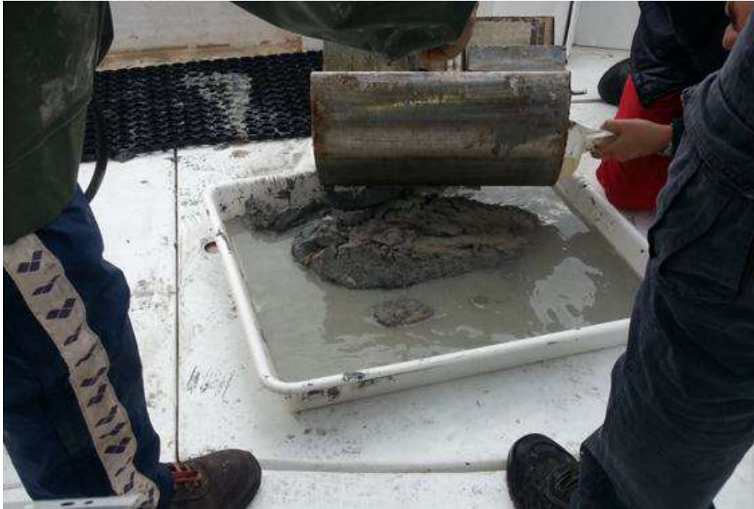
Figura 5.3: Dettaglio di un campione raccolto con la benna
