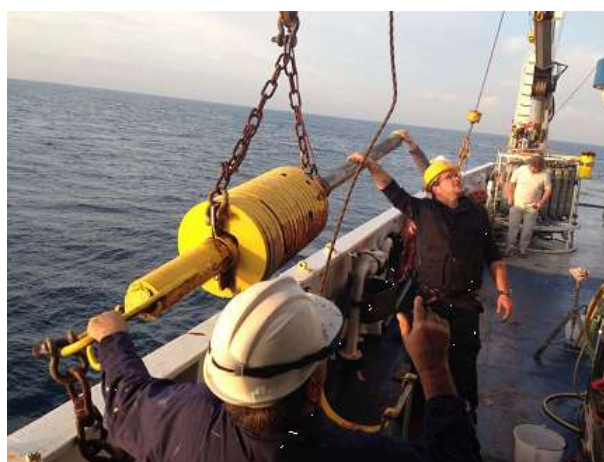
Figura 5.22: Campionamento dei sedimenti mediante carotiere a gravità
