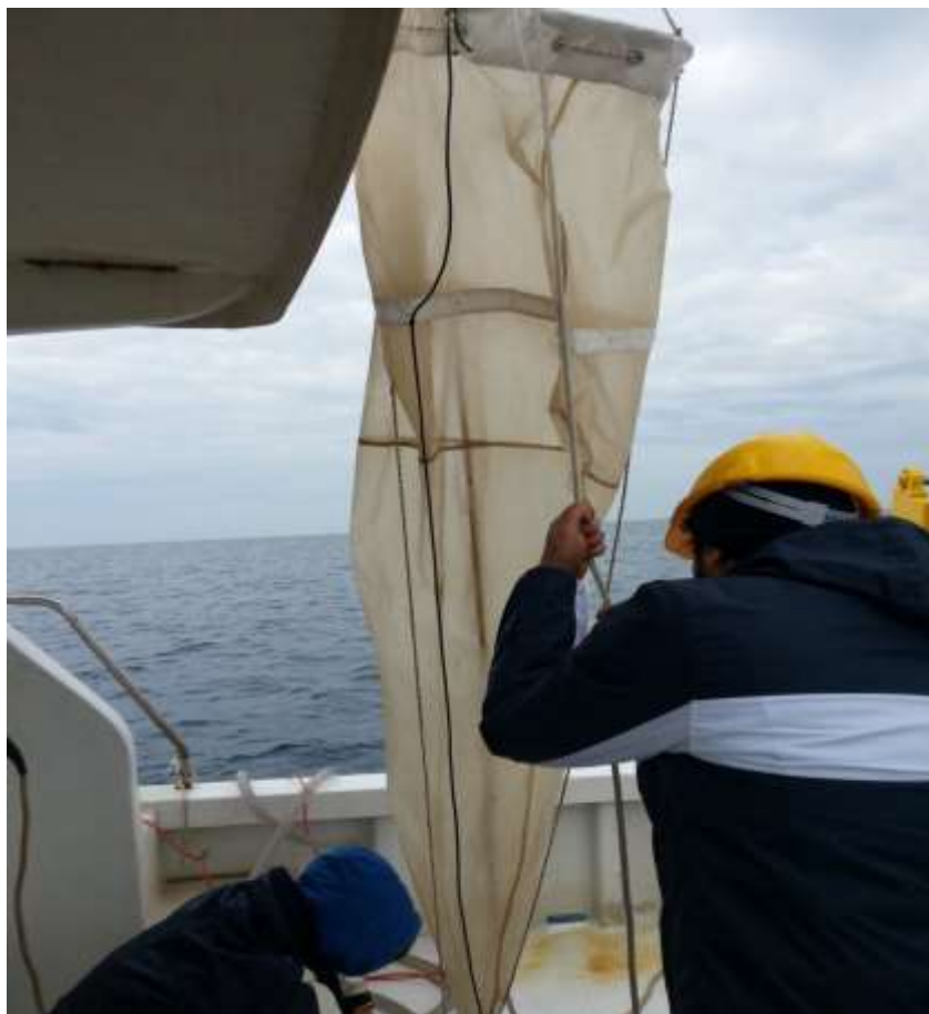
Figura 3.2: Retino utilizzato per il campionamento dello zooplancton
