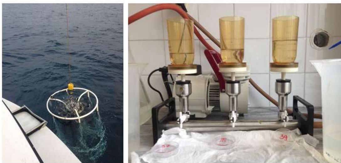
Figura 3.3: Dettaglio di un prelievo superficiale di acqua tramite Niskin, montate in serie su una rosetta (sinistra) e fase di filtrazione del campione a terra (destra)
