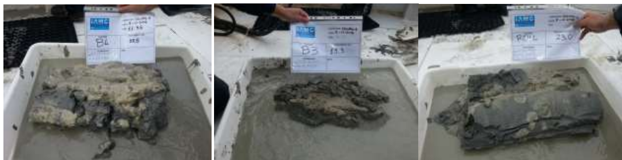
Figura 11.2: Campioni di sedimento superficiale prelevati con l'ausilio di una benna
