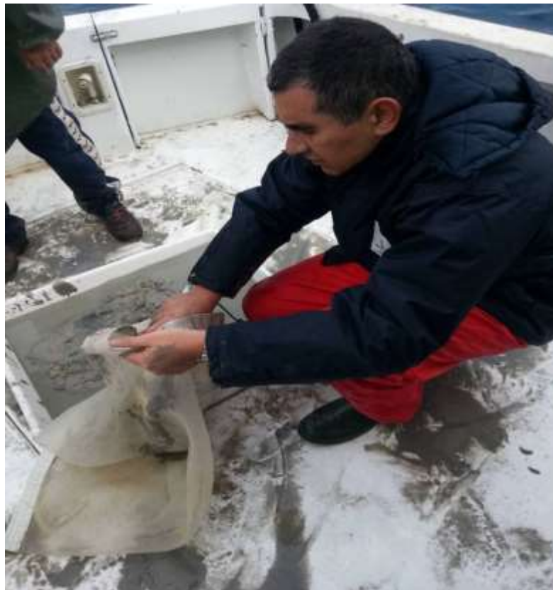
Figura 5.4: Dettaglio di un campione di sedimento pronto per essere setacciato
