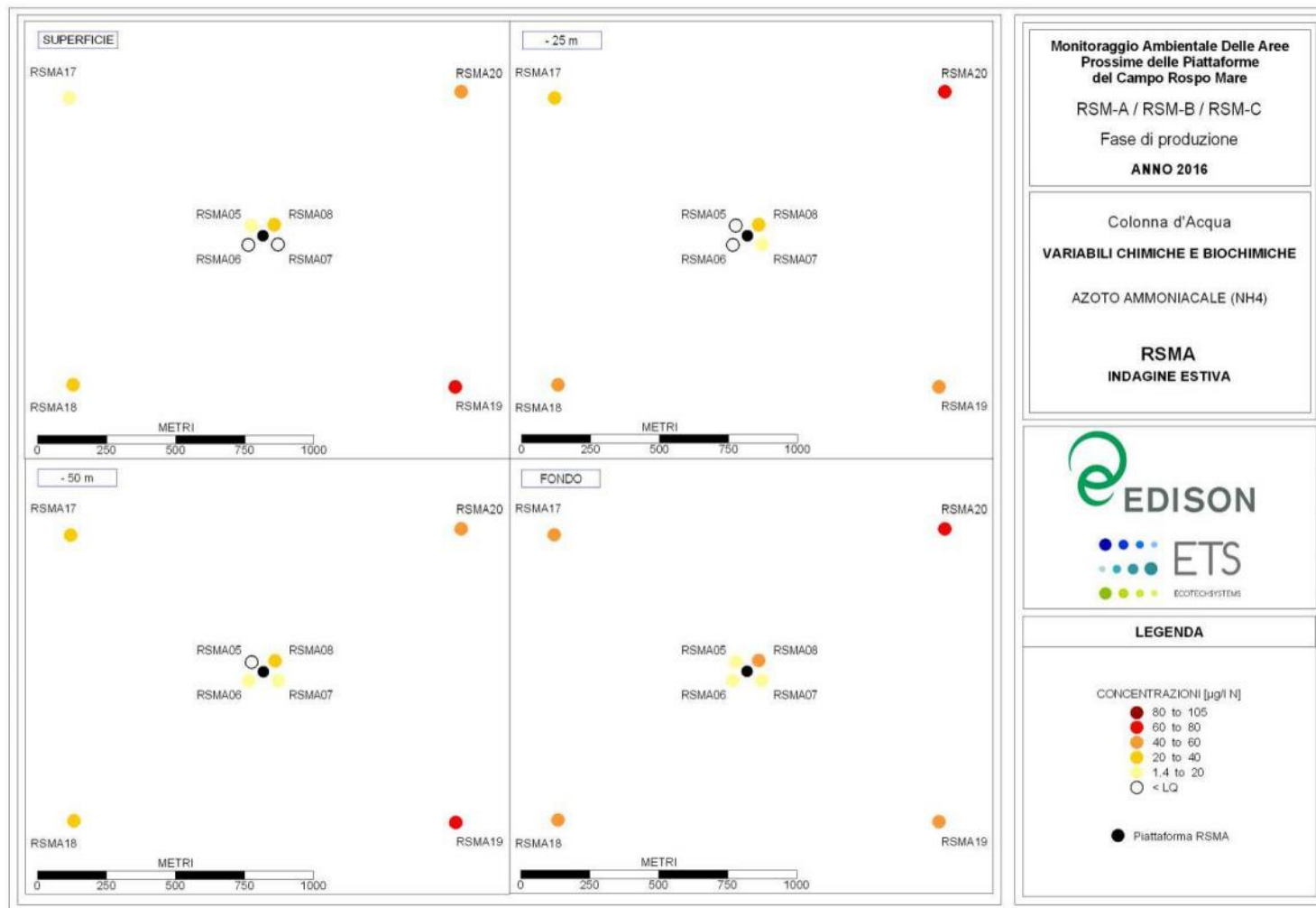
Figura 49. Indagine estiva 2016 – concentrazioni di azoto ammoniacale in prossimità della piattaforma RSMA
