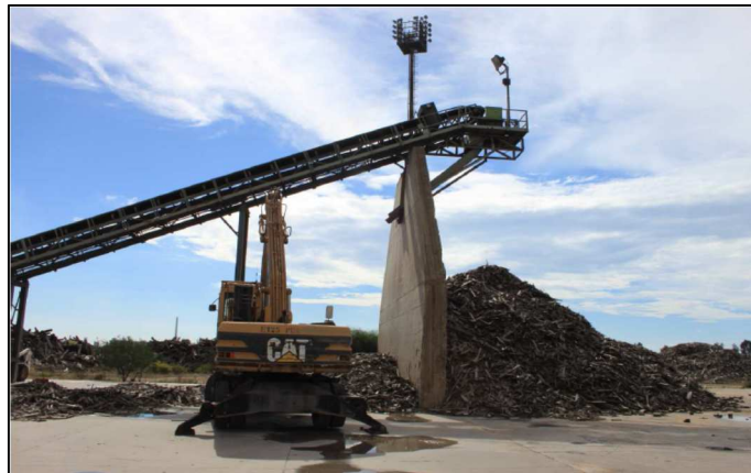
Figura 3.7 Impianto di triturazione del legname.
