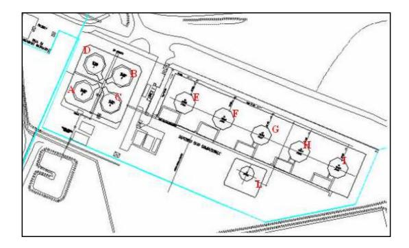
I serbatoi indicati con le lettere E, F, G, H, I e L (tutti di tipo a tetto galleggiante, di capacità di 5,000 m<sup>3</sup> ad eccezione del serbatoio L che ha capacità pari a 1,600 m<sup>3</sup>) furono costruiti tra il 1954 e il 1970 per contenere "virgin nafta" per l'alimentazione del cracking (per la produzione di etilene) a sono stati operativi fino al 1979.
