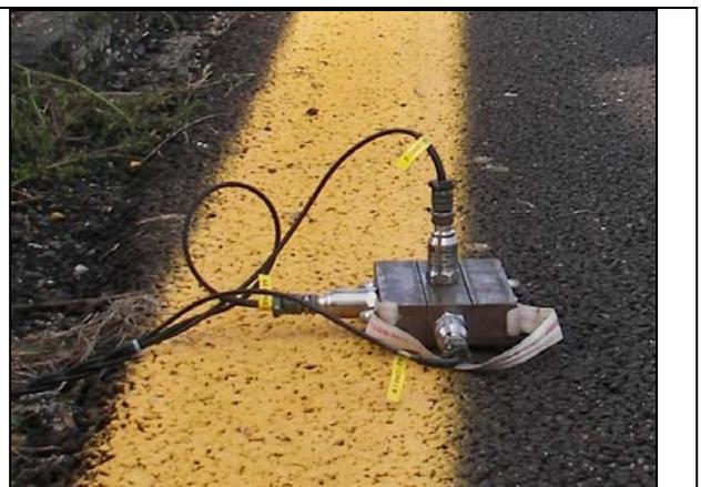
Figura 3.33 Massetto metallico con terna di accelerometri
