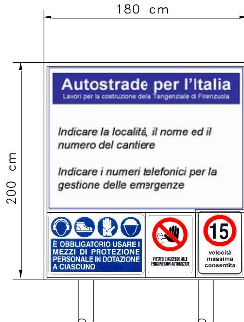
I cantieri stradali e le aree in prossimità delle strade aperte al traffico dovranno conformarsi al D.M. 10/7/2002 "Disciplinare tecnico relativo agli schemi segnaletici, differenziati per categoria di strada, da adottare per il segnalamento temporaneo".
