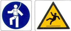
È consentito utilizzare questa misura di prevenzione e protezione esclusivamente per operazioni di durata massima di 8 ore o per la predisposizione di misure di protezione collettiva.
