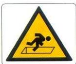
Da utilizzare per scavi la cui dimensione massima è superiore ai quattro metri, oppure che debbano restare aperti per più di un turno di lavoro (8 ore) in tutte le condizioni in cui non è presente traffico stradale o di cantiere senza ostacoli a meno di cinque metri.
