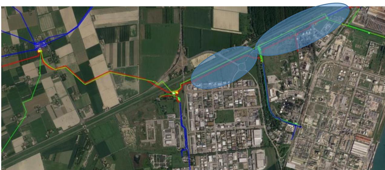
Immagine n.5/7 – tracciato del metanodotto in progetto posizionato su immagine aerea –in azzurro, situazioni che non hanno permesso la posa della nuova condotta in stretto parallelismo con le condotte esistenti– in rosso il tracciato in progetto, in blu met. esistente, in verde met. da sostituire.
