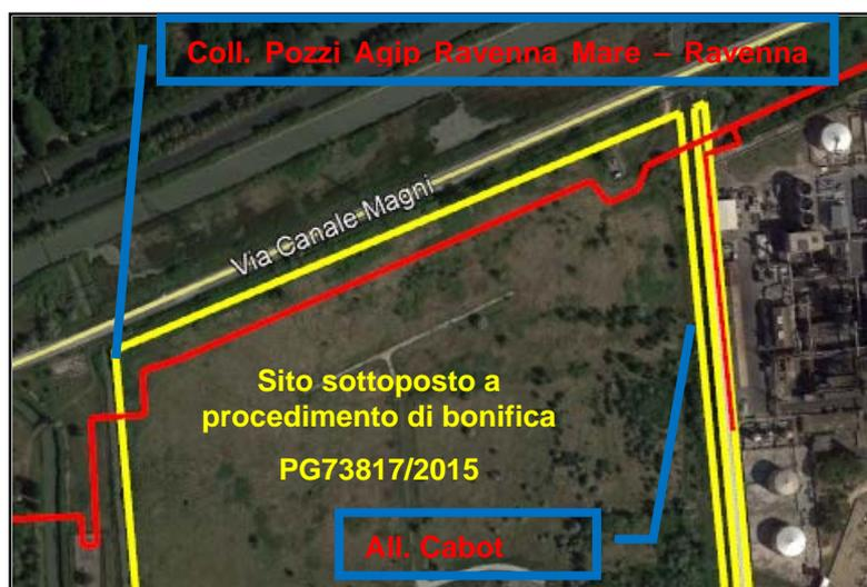
Figura 22.1/A - Sito sottoposto a bonifica (in giallo) e metanodotti interferenti (in rosso)
