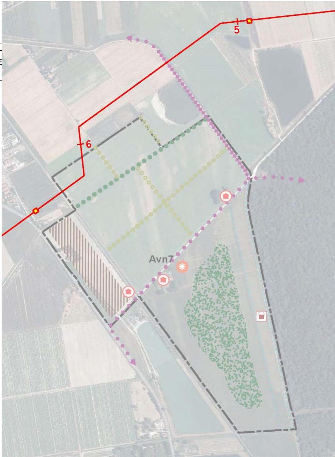
Figura n.23.5.4/3 – tracciato del metanodotto met. Coll. Ravenna Mare – Ravenna Terra DN 650 (26") – DP 75 bar posizionato su stralcio 2° POC – 4C – in rosso il tracciato in progetto, in azzurro soluzione alternativa, in arancio zona di pregio (PSC e RUE).
