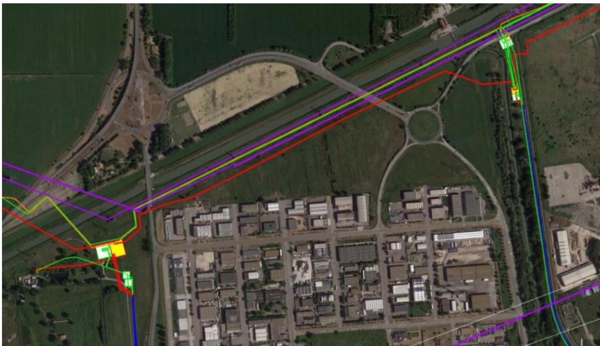
Figura n.5/8– tracciato del metanodotto in progetto posizionato su immagine aerea –in rosso il tracciato in progetto, in blu met. esistente, in verde met. da sostituire e in viola tracciato degli elettrodotti esistenti. In giallo i punti e impianti di linea in progetto, che vanno a sostituire gli impianti esistenti (bianchi con contorno verde) che rappresentano le utenze civili o industriali da ricollegare
