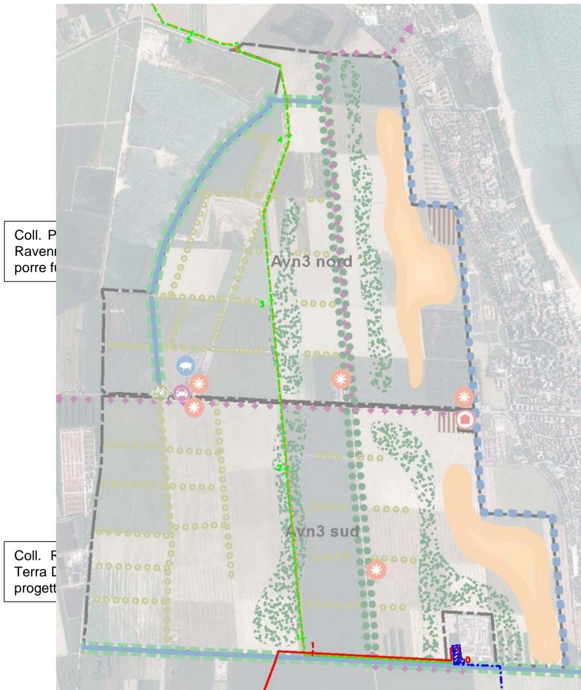
Figura n.23.5.4/1 – tracciato del metanodotto Coll. Ravenna Mare – Ravenna Terra DN 650 (26") – DP 75 bar posizionato su stralcio 2° POC – 4C – in rosso il tracciato in progetto, in verde met. da sostituire, in arancio met. in esercizio da declassare.
