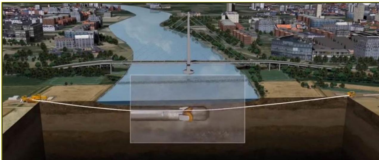
**Figura 8.E – Vista assonometrica di un profilo TOC per attraversamento fluviale.**
