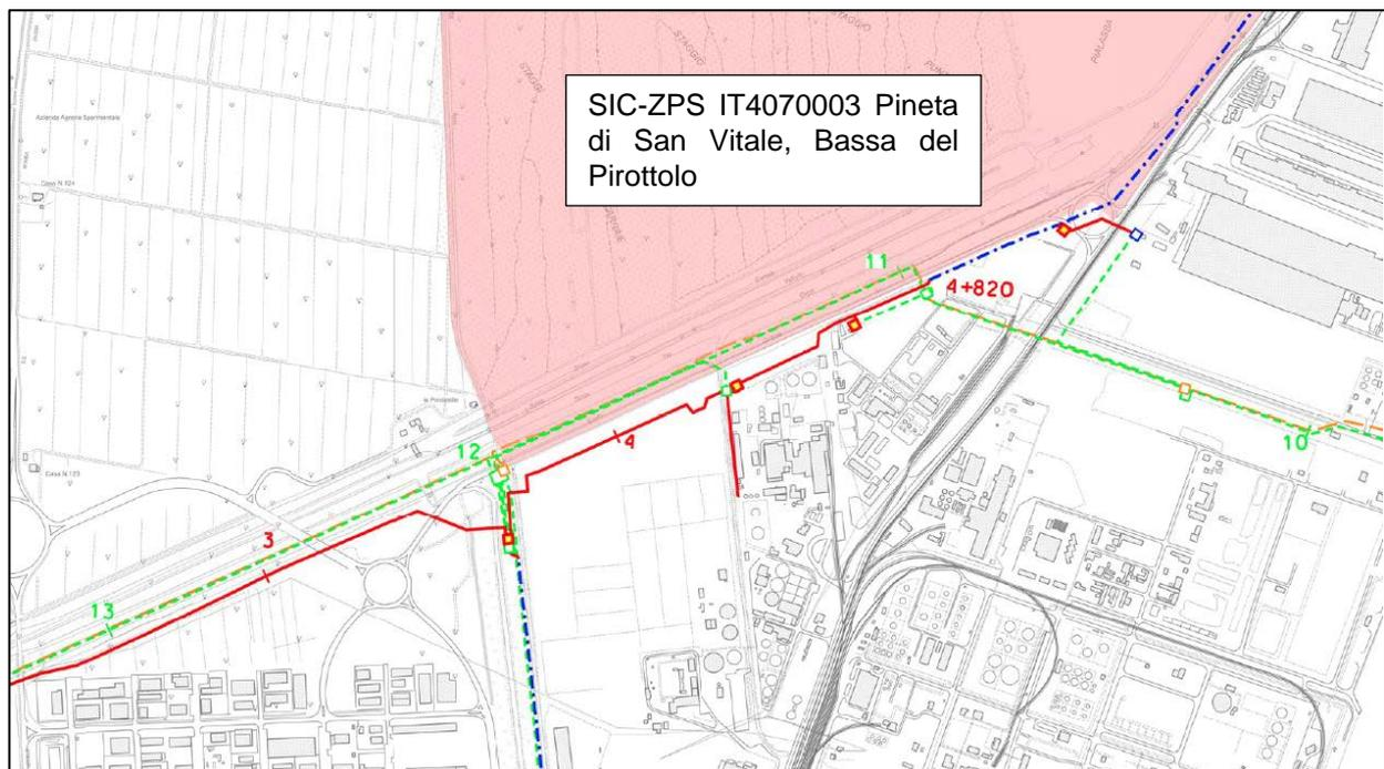
Figura n.23.5.1/3 – tracciato del metanodotto posizionato su CTR con evidenziato il Sito Natura 2000 SIC-ZPS IT4070003 Pineta di San Vitale, Bassa del Pirottolo – in rosso il tracciato in progetto, in blu met. esistente, in verde met. da sostituire.
