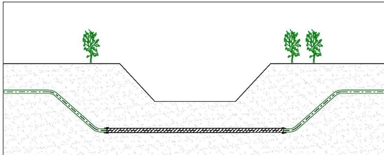
DISMISSIONE ATTRAVERSAMENTO CON INTASAMENTO DELLA CONDOTTA ESISTENTE
