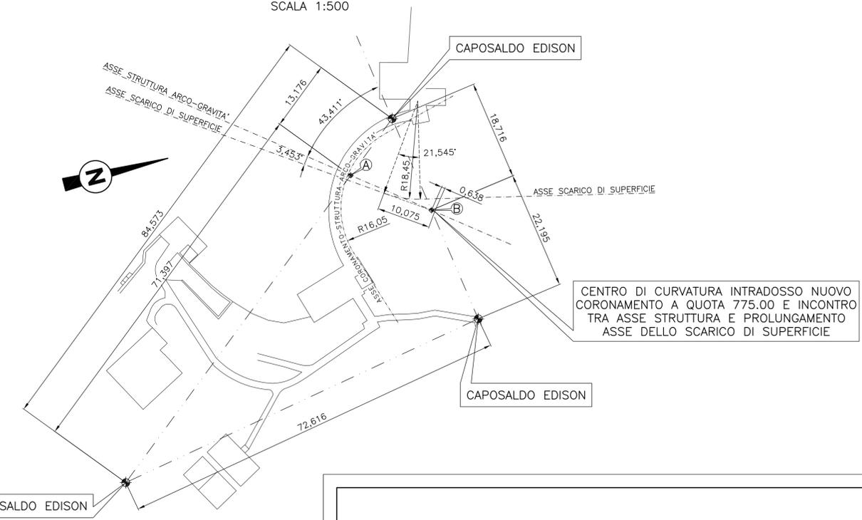
DETTAGLIO TRACCIAMENTO PLANIMETRICO
