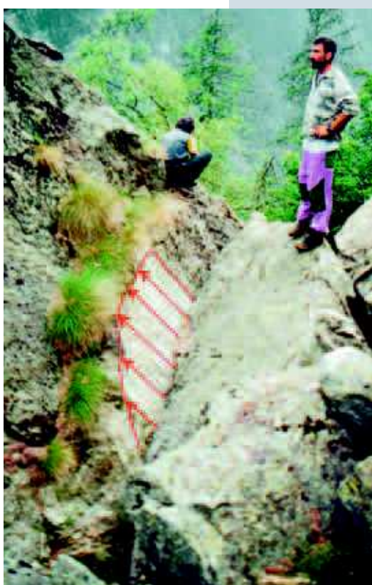
Figura 3.25 ♦ La dislocazione osservabile sulla fotografia, circa 70 cm di abbassamento del comparto a destra, si è sviluppata a seguito delle piogge del maggio-giugno 2002 (foto G. Bossalini).
