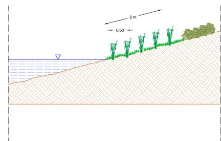
Particolare in pianta - sezione C-C (scala 1:50)
