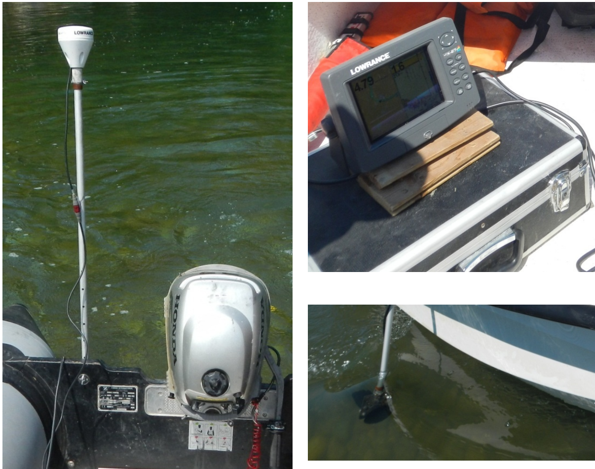
Figura 2: Strumentazione adottata per il rilievo batimetrico
