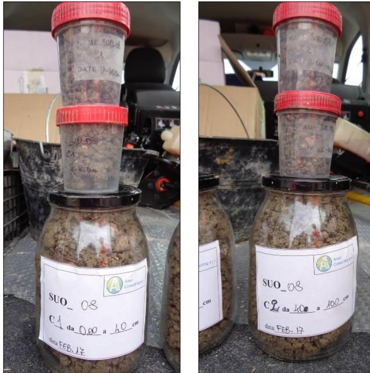
Particolare dei campioni C1 e C2 prelevati dalla trivellata di suolo SUO_08
