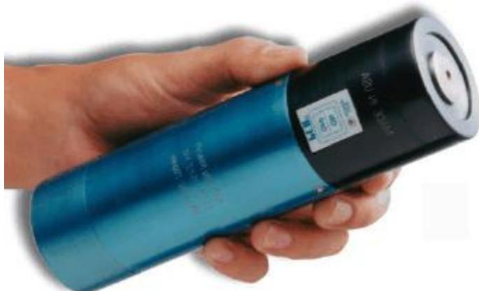
calibratore accelerometrico portatile, 10 m/s<sup>2</sup> at 159.2 Hz.
