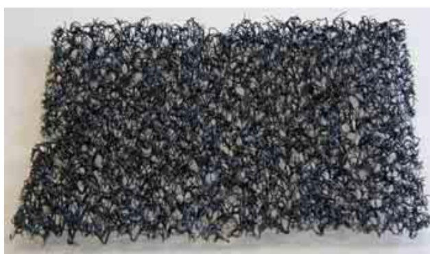
Esempio di struttura di geostuoia
