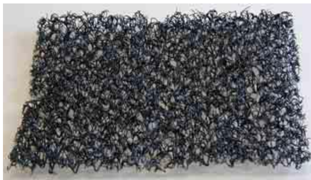
Esempio di struttura di geostuoia
