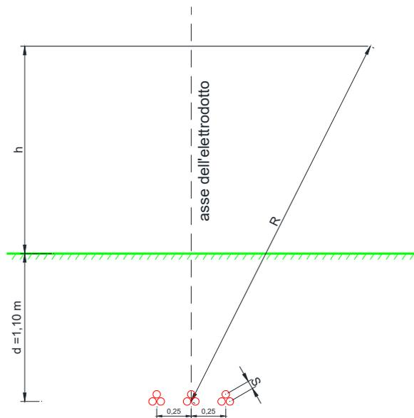
dove B [ $\mu$ T] è l'induzione magnetica in un generico punto distante R [m] dal centro del sistema (baricentro delle terne di cavi),  $S_i$  [m] è la distanza fra i conduttori adiacenti della terna  $i$ -esima, percorsi da correnti simmetriche ed equilibrate di ampiezza pari a  $I_i$  [A] (specifica della terna  $i$ -esima). Sono stati quindi calcolate, fissando vari valori di  $h$ , le distribuzioni dell'intensità del campo magnetico su piani fuori terra paralleli al suolo.
