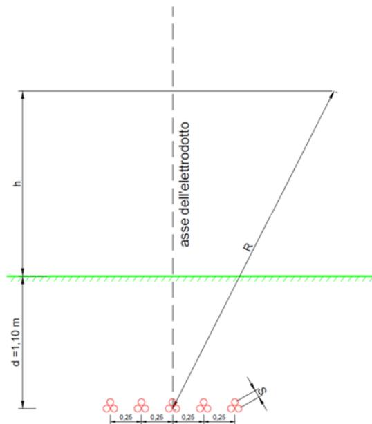
dove B [ $\mu$ T] è l'induzione magnetica in un generico punto distante R [m] dal centro del sistema (baricentro delle terne di cavi),  $S_i$  [m] è la distanza fra i conduttori adiacenti della terna  $i$ -esima, percorsi da correnti simmetriche ed equilibrate di ampiezza pari a  $I_i$  [A] (specifica della terna  $i$ -esima). Sono stati quindi calcolate, fissando vari valori di  $h$ , le distribuzioni dell'intensità del campo magnetico su piani fuori terra paralleli al suolo.
