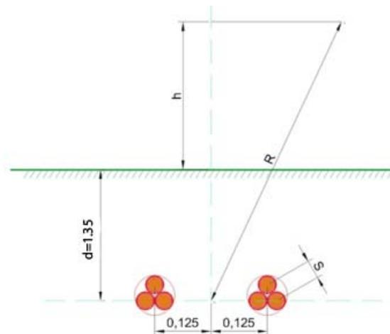
dove B [ $\mu$ T] è l'induzione magnetica in un generico punto distante R [m] dal centro del sistema (baricentro delle due terne di cavi), Si [m] è la distanza fra i conduttori adiacenti della terna i-esima, percorsi da correnti simmetriche ed equilibrate di ampiezza pari a Ii [A] (specifica della terna i-esima).
