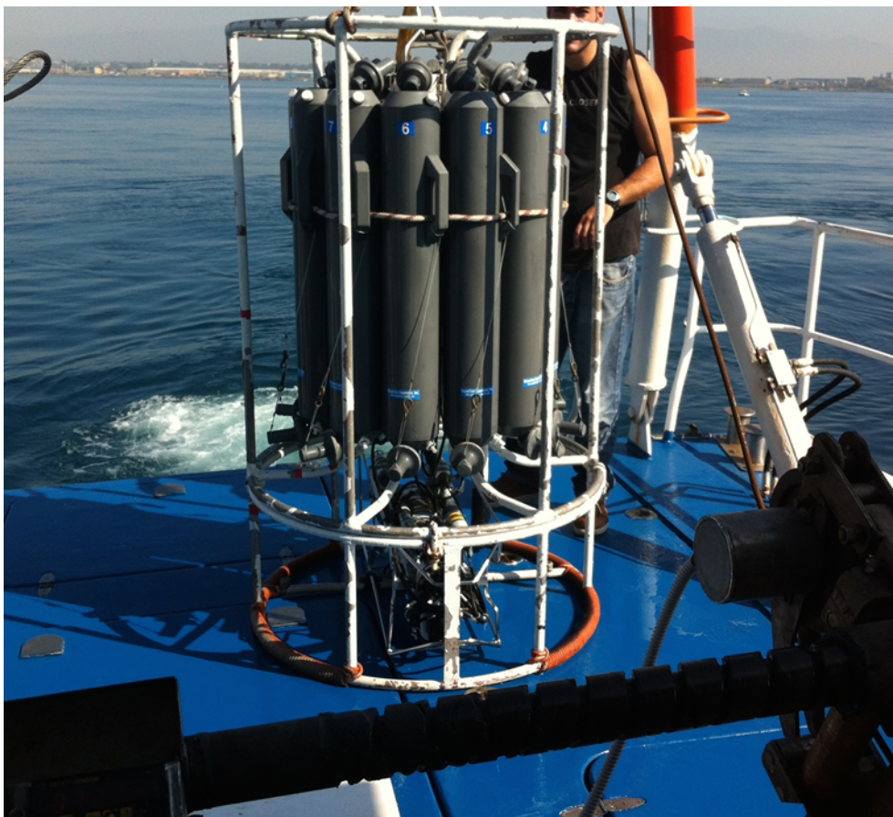
Figura 1.1.1.1. Sonda multi-parametrica (CTD) SBE 911 plus , SeaBird Electronics con multicampionatore di acqua Carousel SBE 32 .
