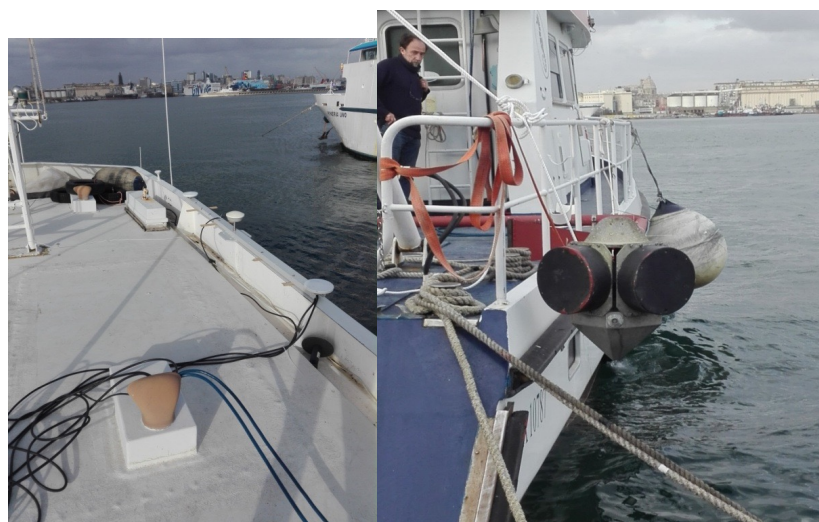
Figura 1.3.2. Antenna per il positioning system (a sinistra) e trasduttori installati sul palo (a destra).
