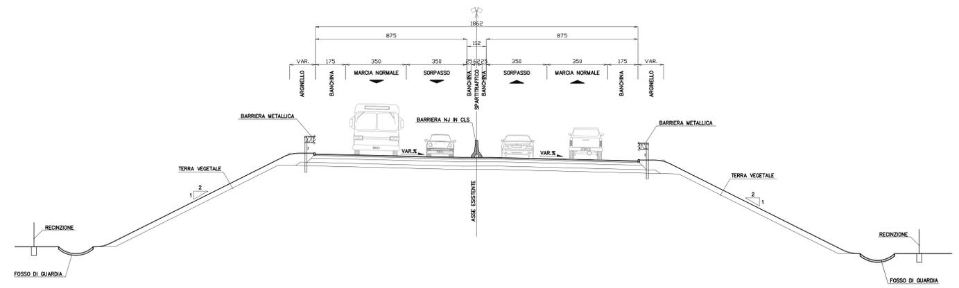
SEZIONE TIPO IN SCAVO (RETTIFILO) – scala 1:100
