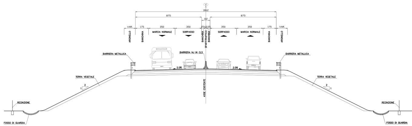
SEZIONE TIPO IN RILEVATO (CURVA) – scala 1:100
