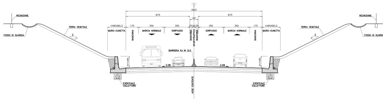
SEZIONE TIPO IN SCAVO (CURVA) – scala 1:100
