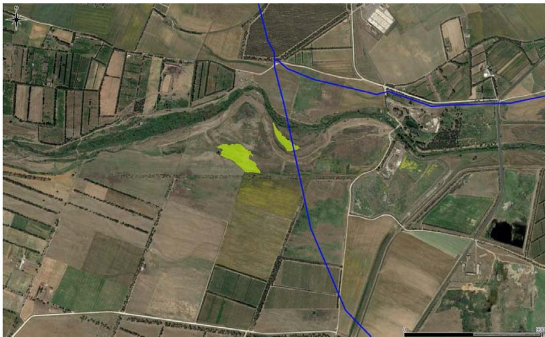
**Fig. 1.1/B:** Met. Cagliari – Palmas Arborea DN 650 (26''): Interferenza con area a pascolo percorsa dal fuoco nel 2016 nel comune di Villacidro
