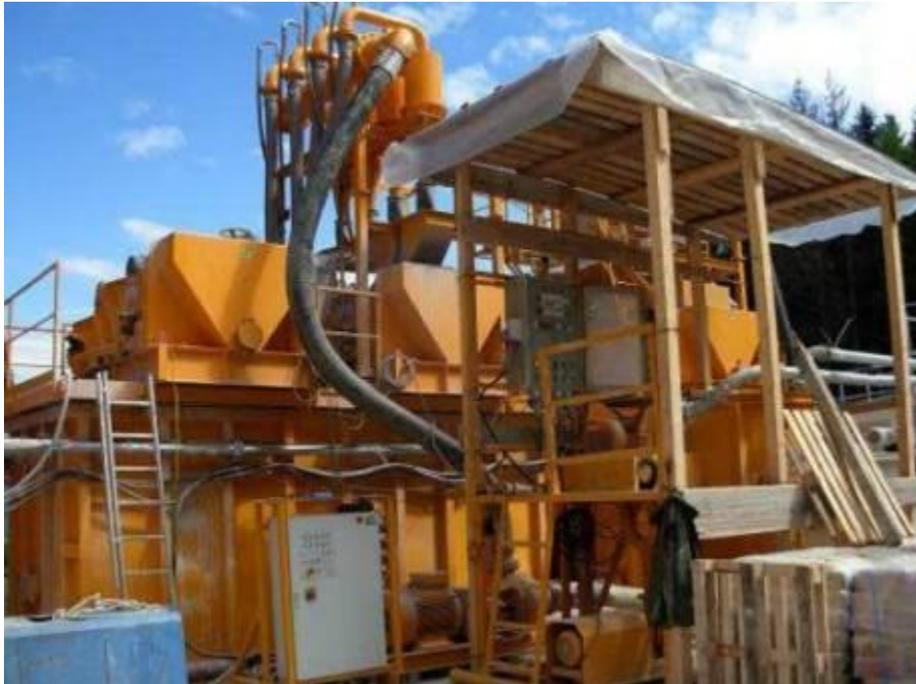
**Fig. 9.10/D** – Sistema di disidratazione
