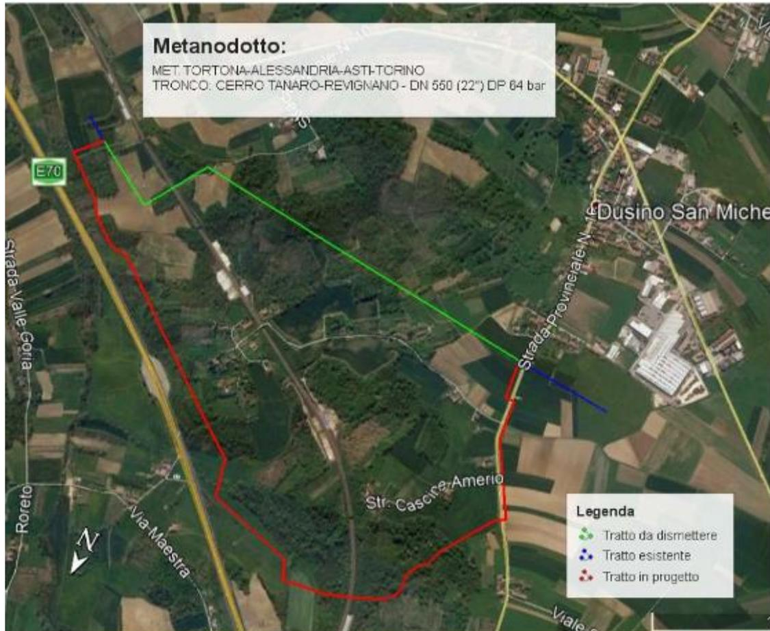
**Fig. 1.1/B** – Stralcio immagine aerea con localizzazione delle aree d'intervento (in rosso il tracciato di progetto, in verde il tracciato in dismissione, in blu quello in esercizio)
