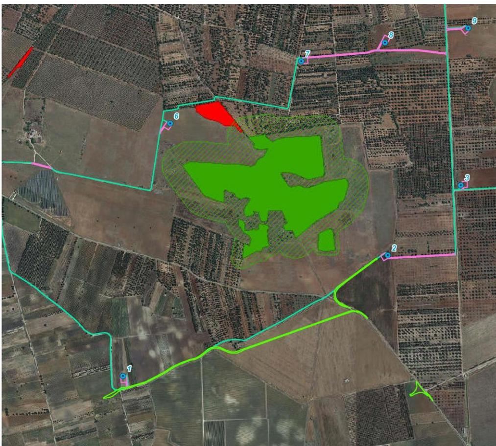
**Fig. 2 –Cavidotti interrati e perimetrazione delle Componenti botanico vegetazionali del PPTR nei pressi dell’aerogeneratore n. 6 di progetto**
