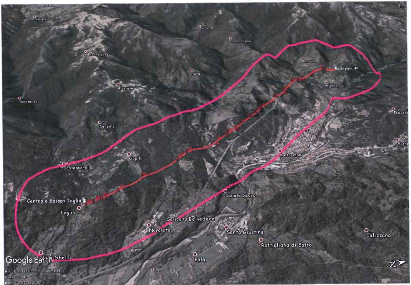
Figura 3-3: Panoramica dell'Alternativa 2 Fascia di studio — Tracciato elettrodotto 132 kV C. Edison – sostegno 40
