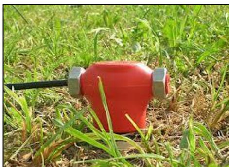
**Fig. 23-** Geofono 4.5 Hz Geospace
