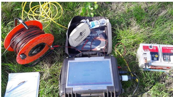
*Figura 6: Sismografo digitale a 24 bit.*
