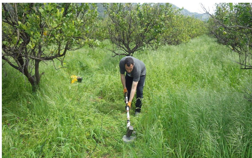
Fig. 3 –Energizzazione Prove Sismiche
