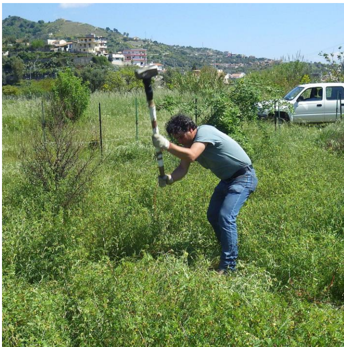
Fig. 6 - Energizzazione Prova MASW
