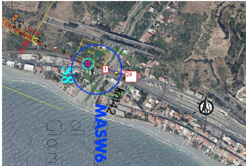
Figura 7.17 – Traccia dello stendimento sismico relativo alla prova MASW 6, della lunghezza di 57,5 metri, in corrispondenza della piazzola del sondaggio S6App.
