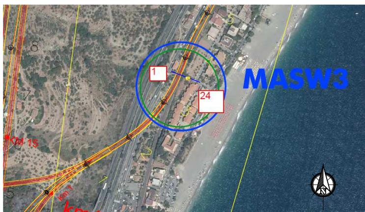
Figura 7.8 – Traccia dello stendimento sismico relativo alla prova MASW 3, della lunghezza di 57,5 metri.
