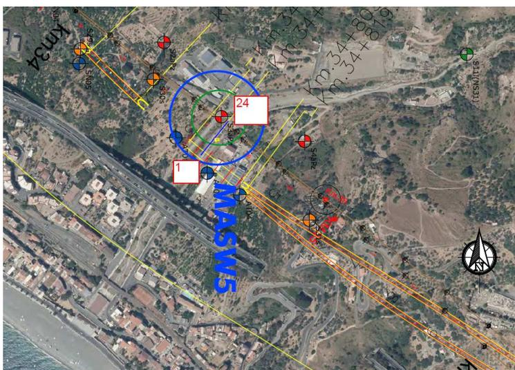
Figura 7.14 – Traccia dello stendimento sismico relativo alla prova MASW 5, della lunghezza di 57,5 metri.
