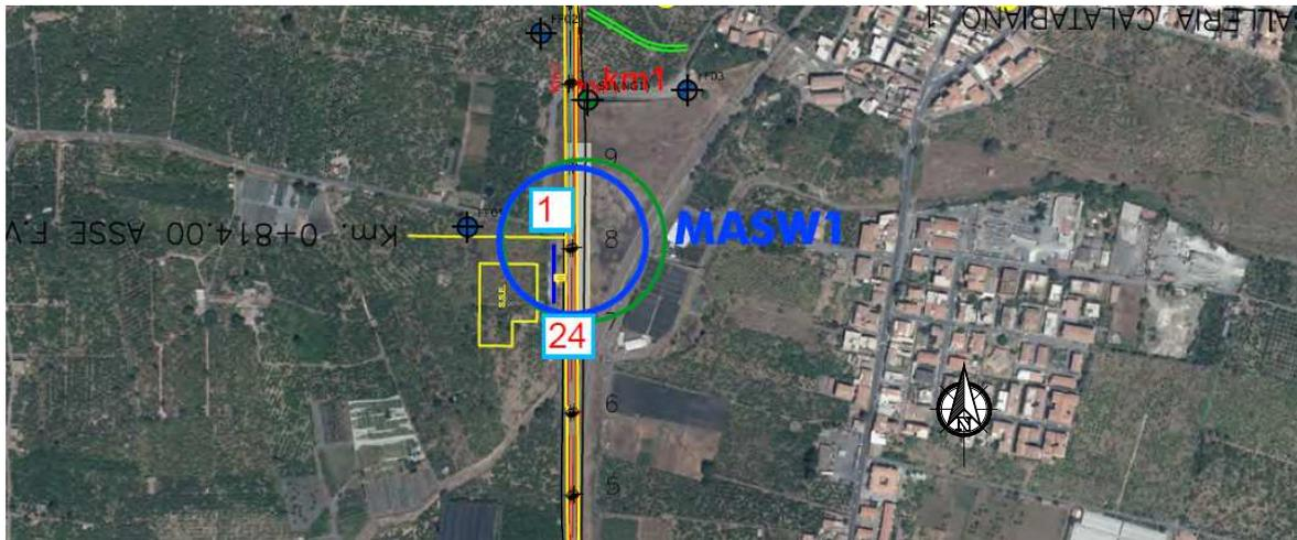
Figura 7.2 – Traccia dello stendimento sismico relativo alla prova MASW 1, della lunghezza di 57,5 metri.
