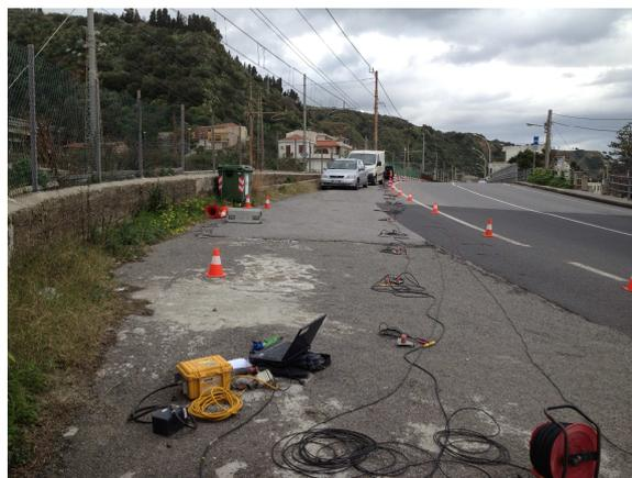
Figura 4.3 – Strumentazione per l'esecuzione della prova di sismica attiva MASW; foto scattata in corrispondenza della piazzola del sondaggio S6.
