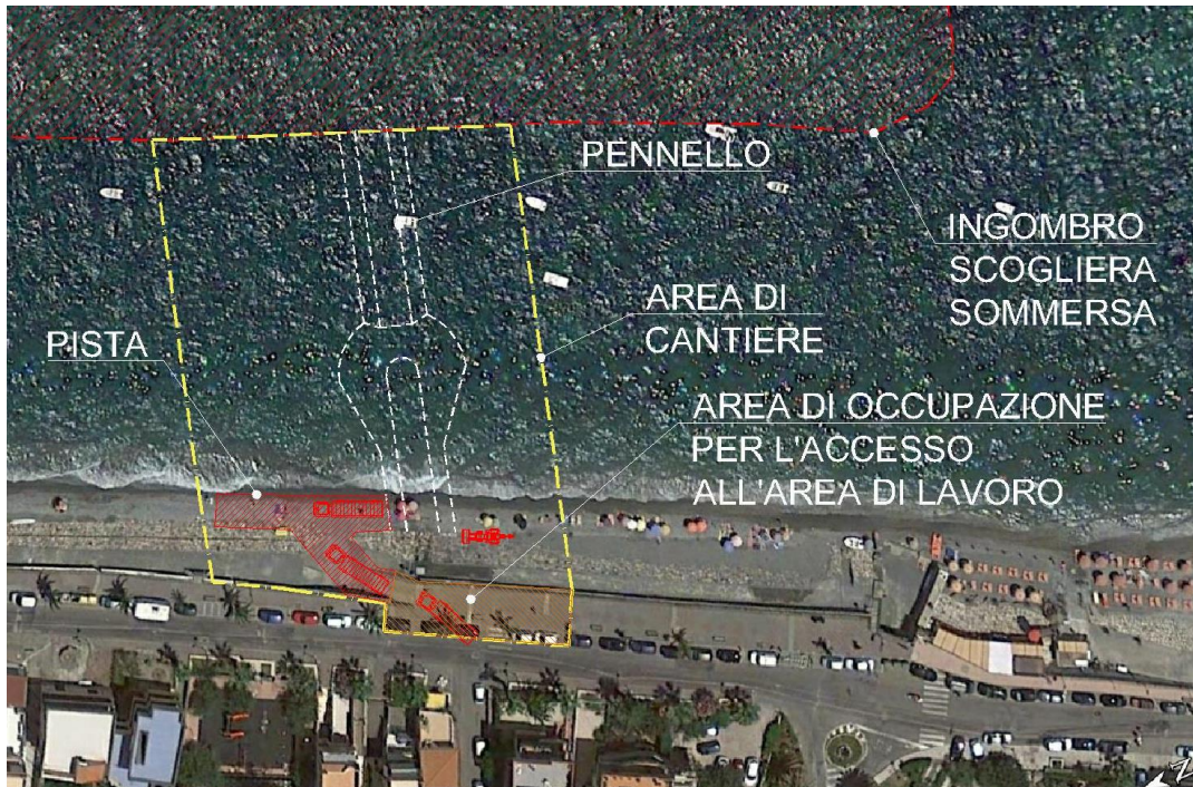
Figura 6-2: Esempio dell'area di cantiere per la costruzione di un pennello
