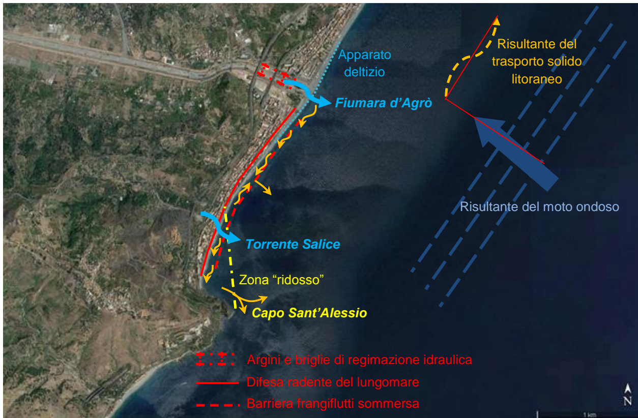
Figura 5-7: Schematizzazione dei processi di evoluzione morfologica che attualmente interessano il litorale in esame e dei principali elementi di interferenza antropica
