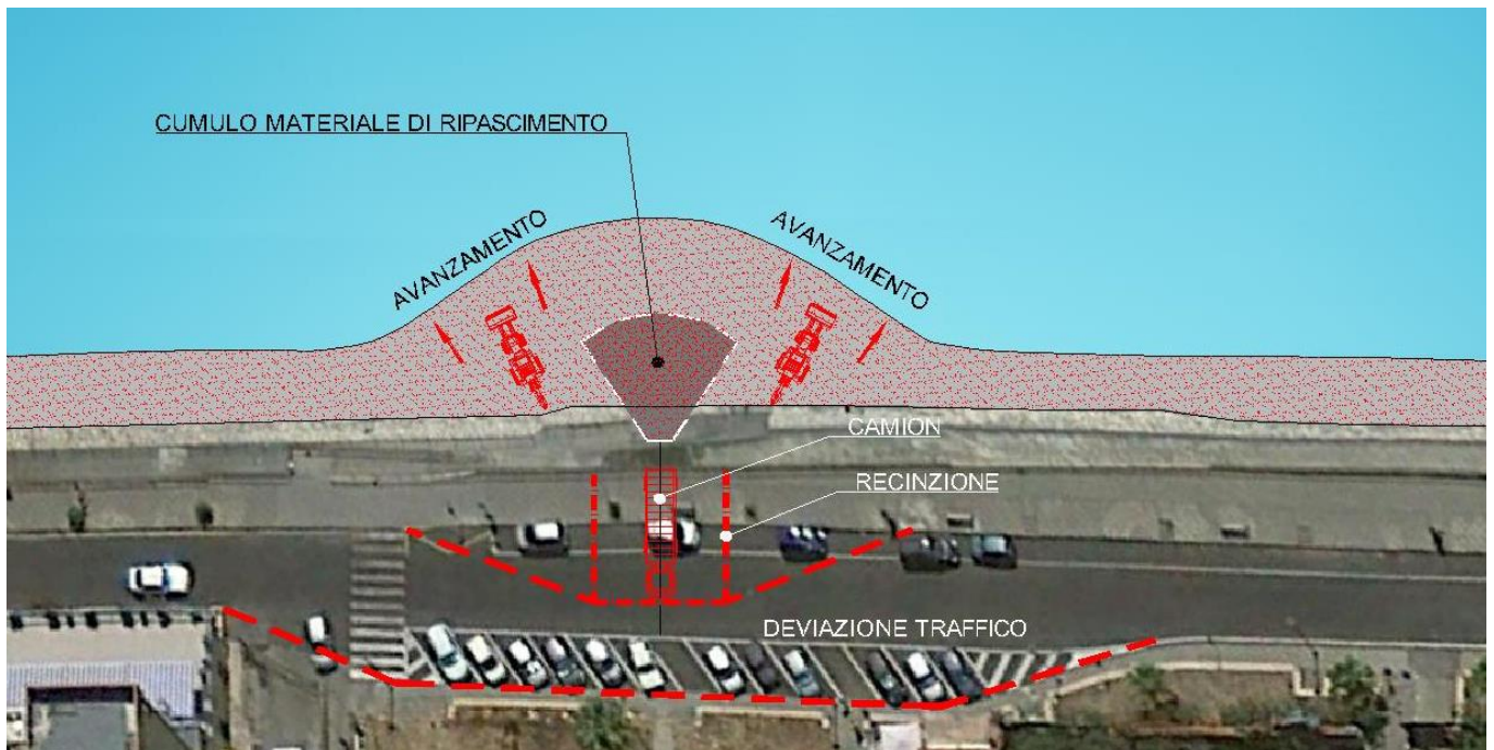
Figura 6-3: Schema di versamento e spandimento del materiale di ripascimento
