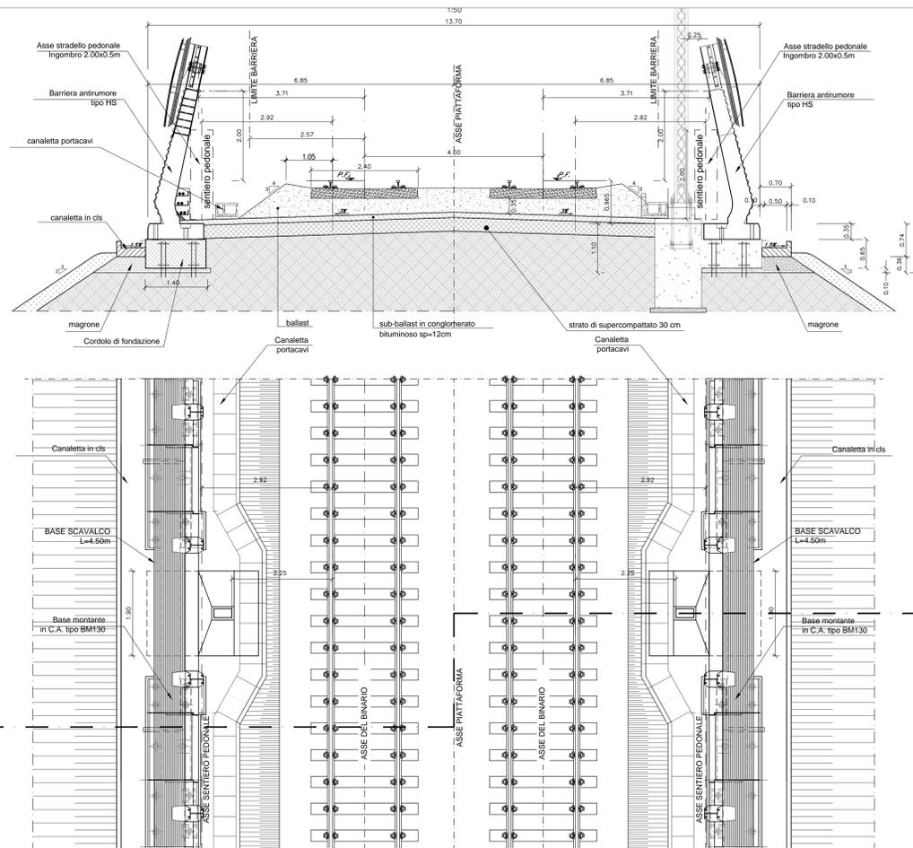
SEZIONE TIPO IN TRINCEA CON BARRIERA ANTIRUMORE
