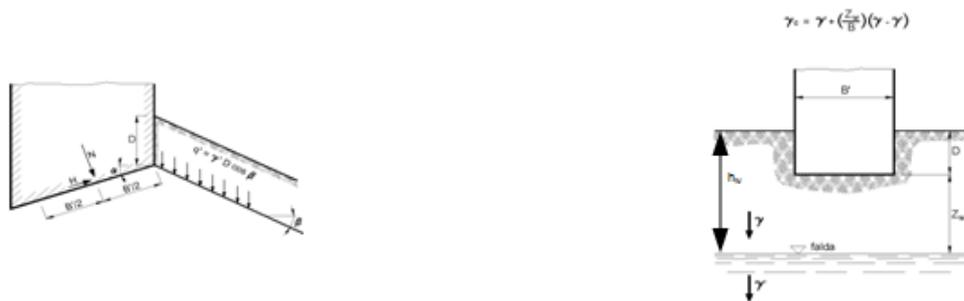
Fig. 11 – Schemi per il calcolo della capacità portante delle fondazioni dirette
