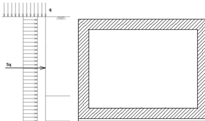
Fig. 3 – Schema per il calcolo degli effetti della spinta dovuta al sovraccarico accidentale
