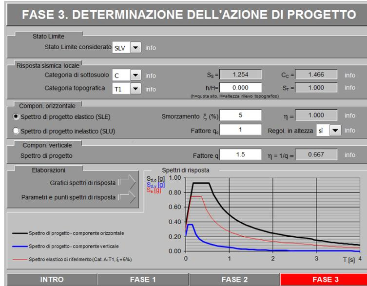
Di seguito si riporta a titolo di esempio lo **spettro di progetto** per lo **Stato Limite di salvaguardia della Vita SLV** relativamente alle componenti **orizzontali**, con coefficiente di smorzamento strutturale canonico pari al 5%.
