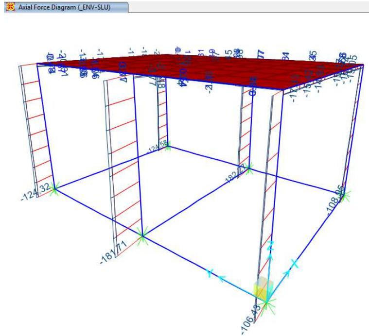
**Figura 9-1. Involuppo SLU – Sforzo Normale**
