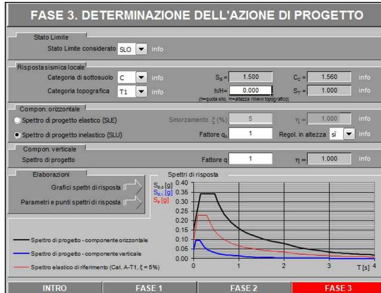
Di seguito si riporta a titolo di esempio lo **spettro elastico** per lo **Stato Limite di salvaguardia della Vita SLO** relativamente alle componenti **orizzontali**, con coefficiente di smorzamento strutturale canonico pari al 5%.
