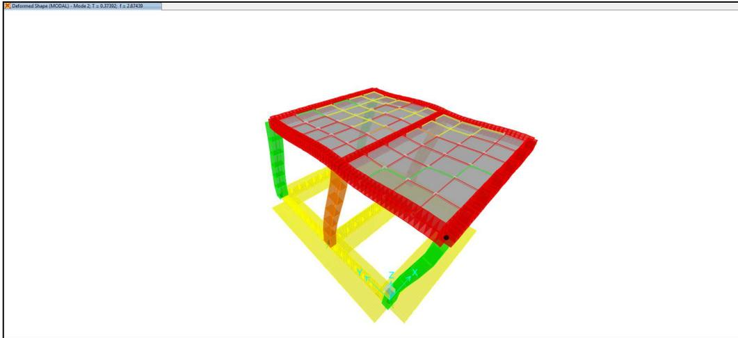
**Figura 7-3 Secondo modo di vibrazione (Traslazionale in Y)**
