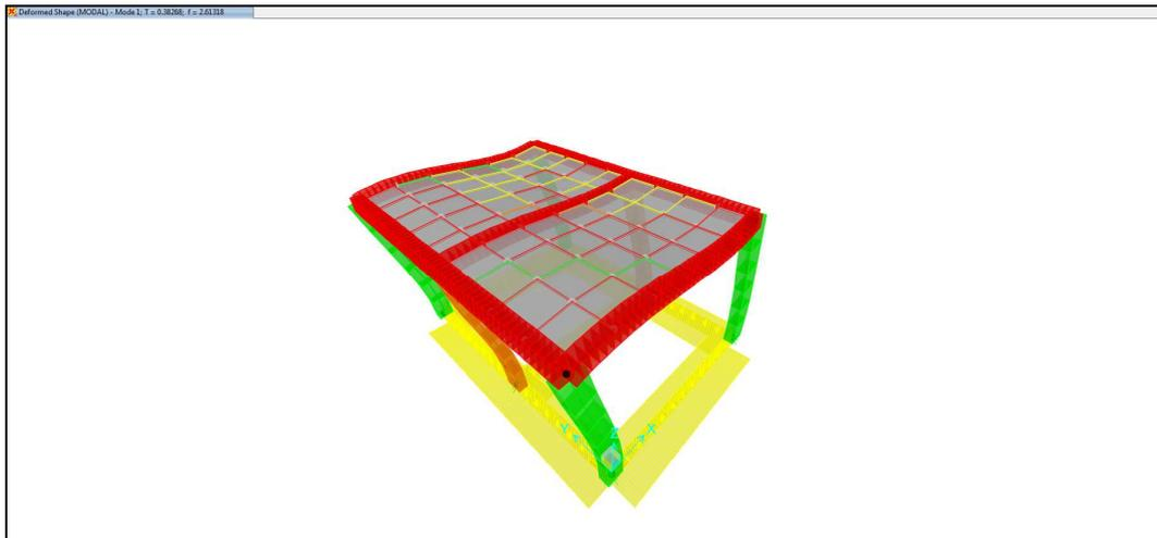
Figura 7-2 Primo modo di vibrazione (Traslazionale in X)
