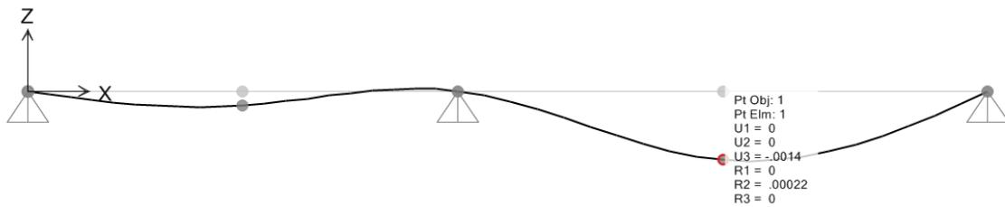
Figura 9-1. Spostamento elastico dovuto ai permanenti
