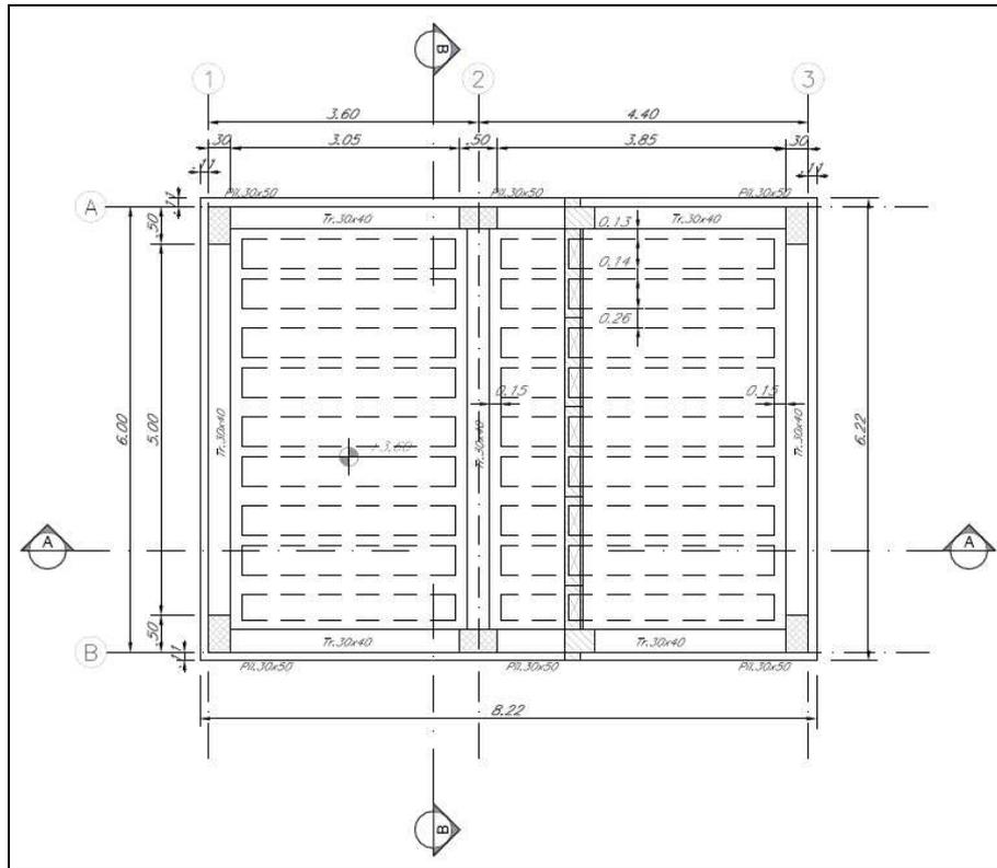
**Figura 1-2. Carpenteria copertura.**
