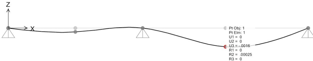
Figura 9-1. Spostamento elastico dovuto ai permanenti + variabili
