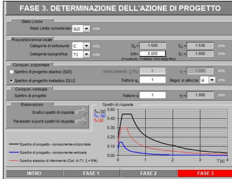
Di seguito si riporta a titolo di esempio lo **spettro elastico** per lo **Stato Limite di salvaguardia della Vita SLD** relativamente alle componenti **orizzontali**, con coefficiente di smorzamento strutturale canonico pari al 5%.
