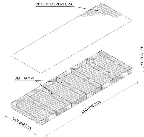
POSA DEI MATERASSI TIPO RENO ASSEMBLATI E RIEMPIMENTO
