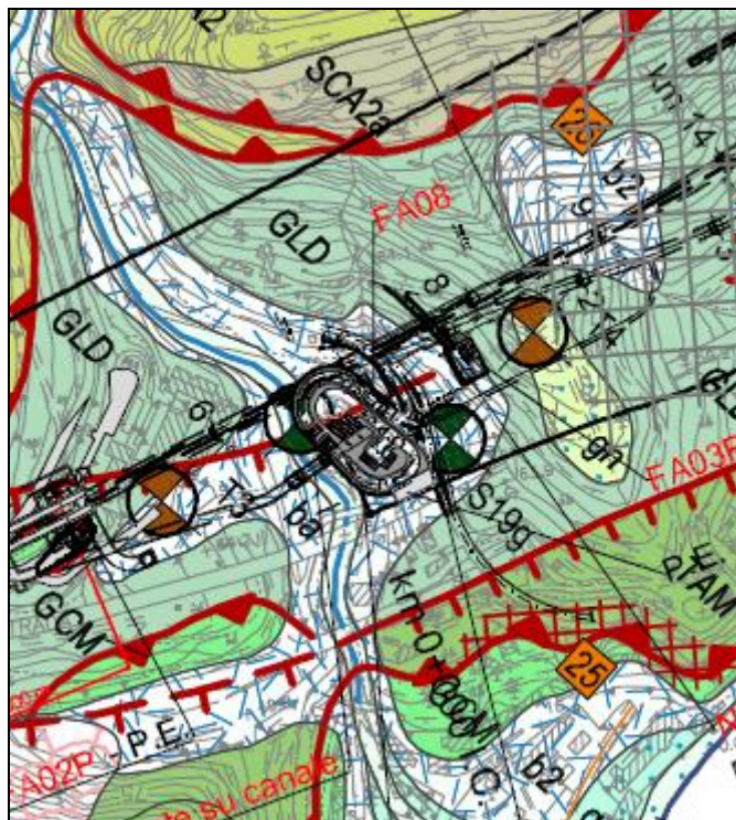
Figura 3- Ubicazione dei sondaggi geognostici in pianta pk 13+600-13+800
